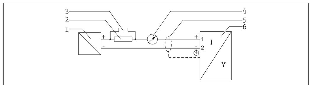
10 Schéma de principe 2 fils : 4-20 mA HART
