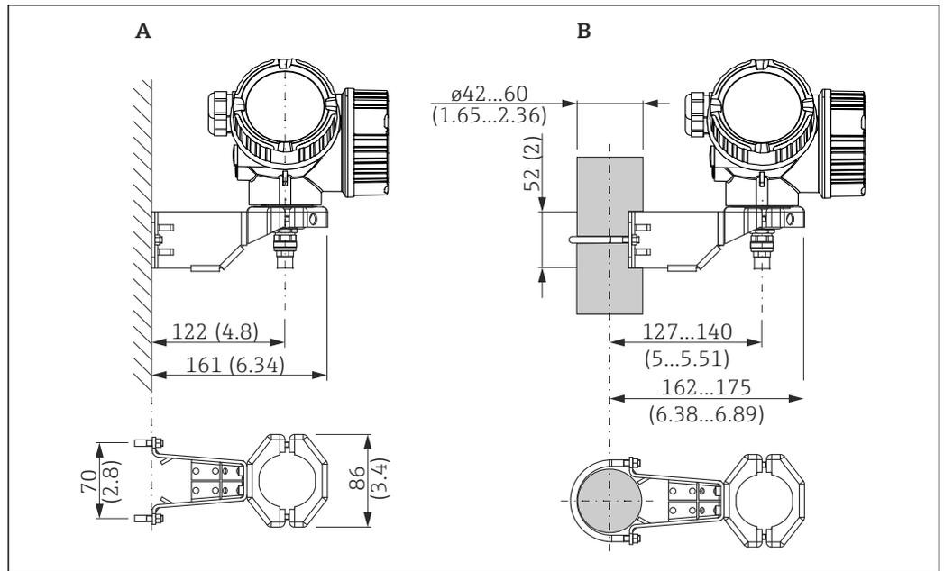
7 Montage du boîtier de l'électronique avec le support de montage. Unité de mesure mm (in)
