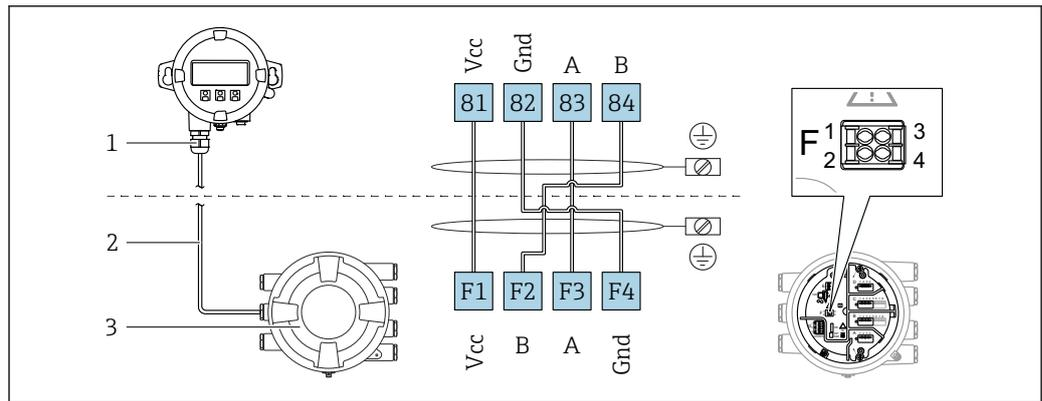
6 Conexión del módulo de indicación y configuración a distancia DKX001 al equipo de medición de depósitos (NMR8x, NMS8x o NRF8x)
