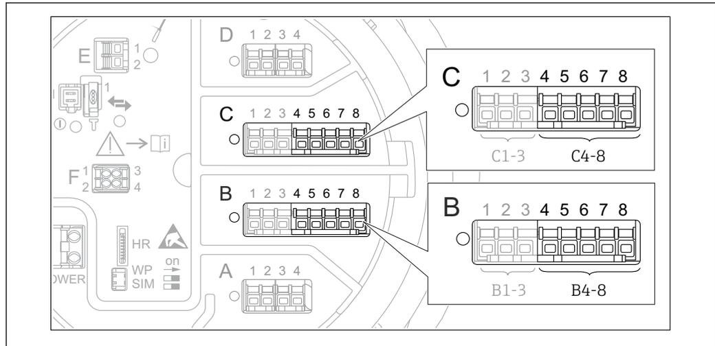
46 Terminales para Submenú "Analog IP" ("B4-8" o "C4-8", respectivamente)
