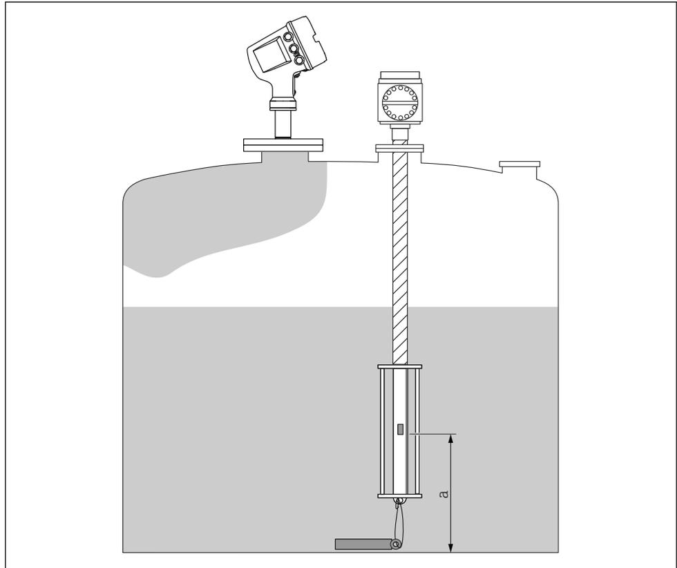
Fig. 27 Prothermo NMT53x: posición del elemento de temperatura inferior
