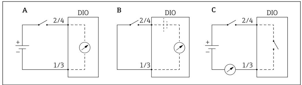
49 Modos de funcionamiento del módulo E/S digital
