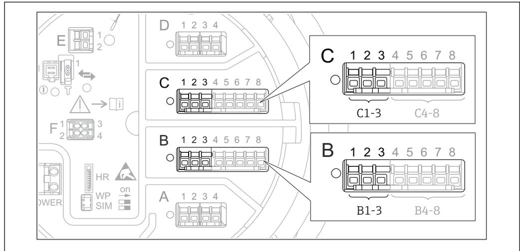
47 Terminales para el Submenú "Analog I/O" ("B1-3" o "C1-3", respectivamente)
