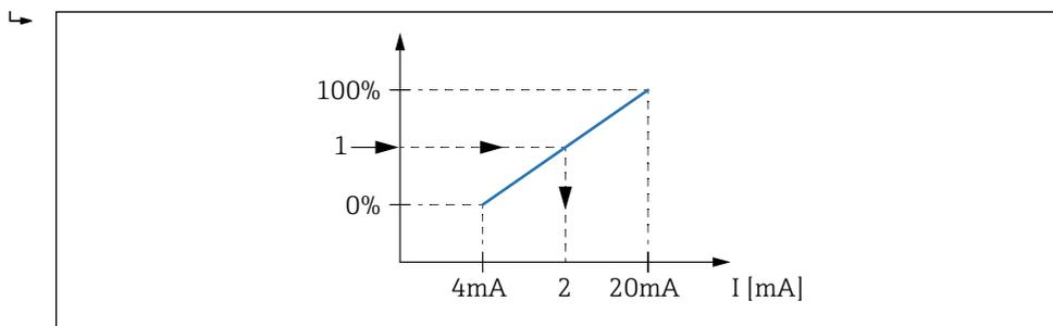
37 Escalado de la variable del depósito a la corriente de salida
