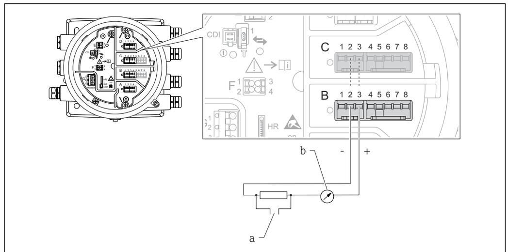
**11** Uso activo del módulo de E/S analógica en el modo de salida
