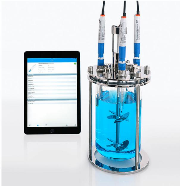
2 Exemple d'application dans un fermenteur, avec une tablette pour la configuration
