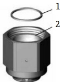
Rys. 71. Centrowanie uszczelki na powierzchni uszczelniającej osłony
