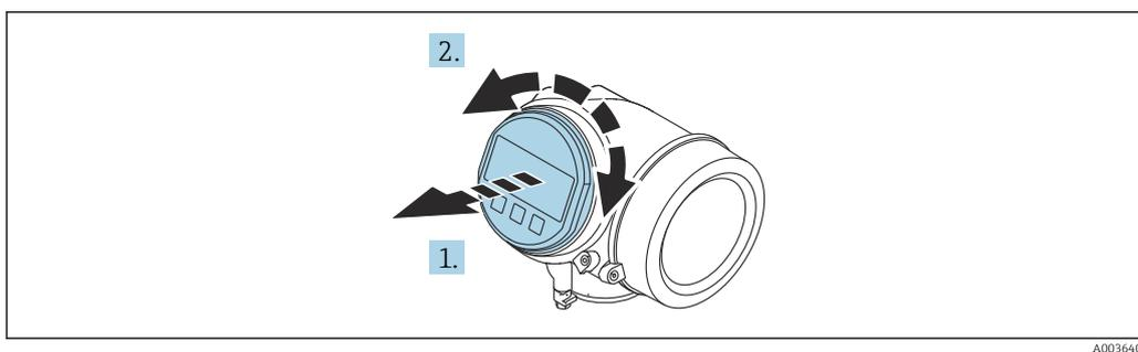
1. Плавным вращательным движением извлеките дисплей.
