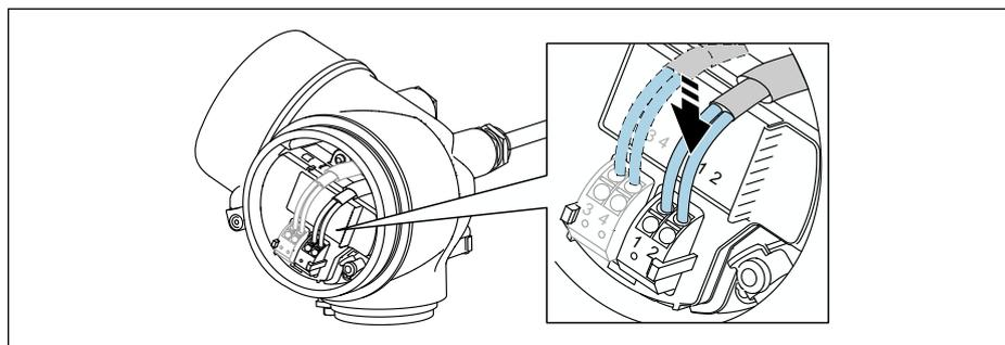
6. При использовании экранированных кабелей: подсоедините экран кабеля к клемме заземления.
