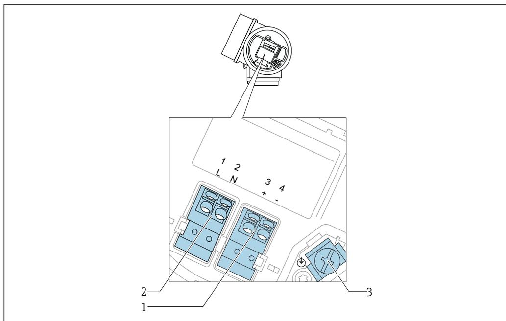
14 Назначение клемм, 4-проводное подключение; 4–20 мА HART (90 до 253 V<sub>AC</sub>)
