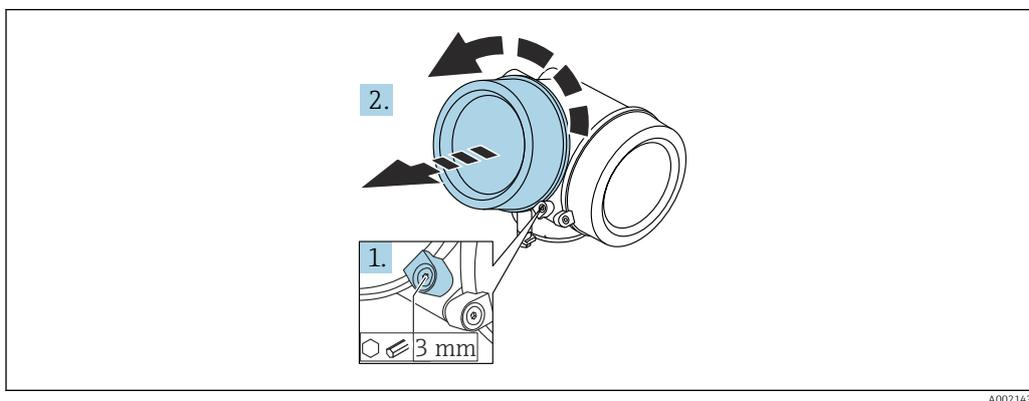
1. Ослабьте винт зажимного хомута крышки отсека электронной части с помощью шестигранного ключа (3 мм) и поверните хомут на 90 град против часовой стрелки.
