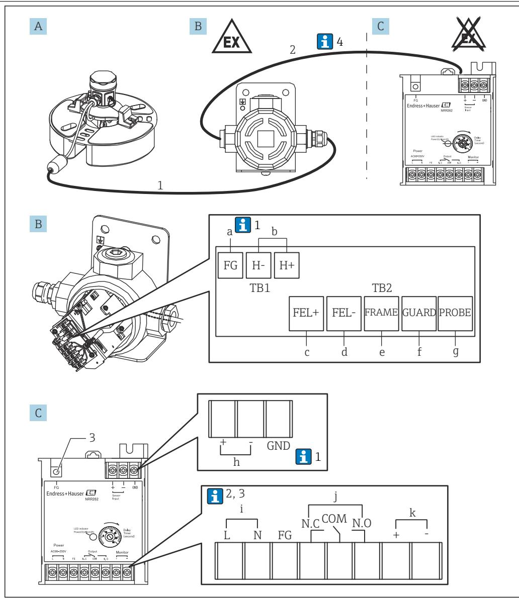
图 8 本安防爆型 (Ex [ia]) 变送器 NRR262-2/A/B/C 接线示意图
