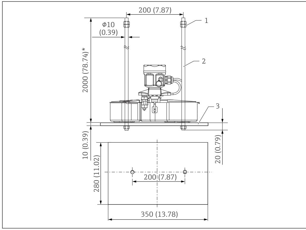
图 21 浮子连接杆。测量单位 mm (in)
