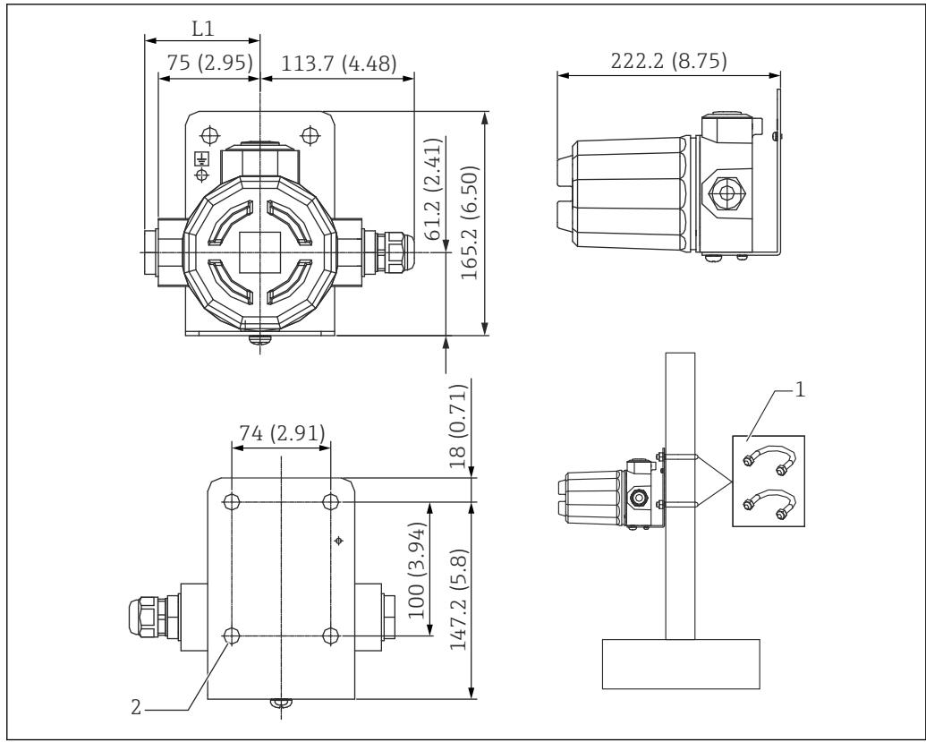
图 17 本安防爆型 (Ex [ia]) 传感器数据转换盒的外形尺寸。测量单位 mm (in)
