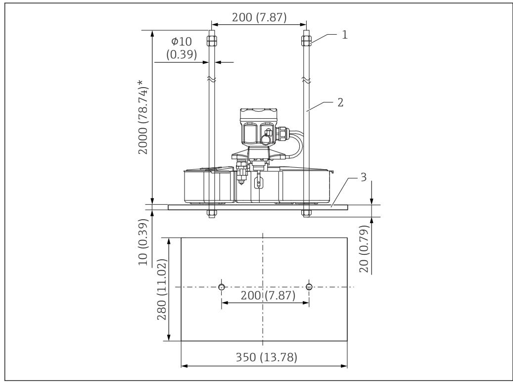
图 13 NAR300/浮子连接杆。测量单位 mm (in)
