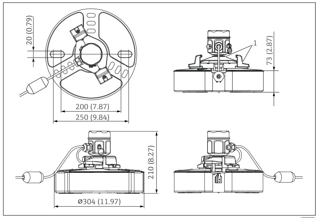
图 14 NAR300 浮子传感器的外形尺寸。测量单位 mm (in)
