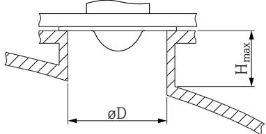
**i** これより長いノズルを使用した場合、測定性能が低下します
