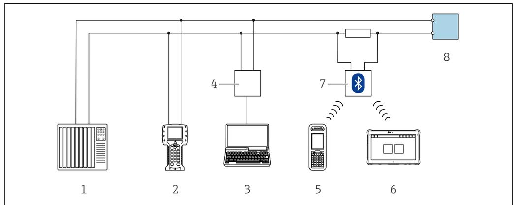
Fig. 26 Opções para operação remota através do protocolo HART (ativa)
