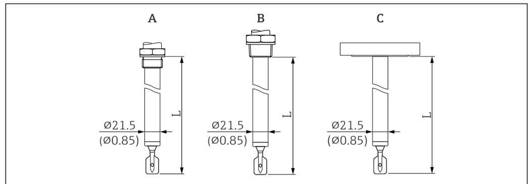
37 Design della sonda: tubo di estensione, tubo corto, lunghezza sensore L. Unità di misura mm (in)
