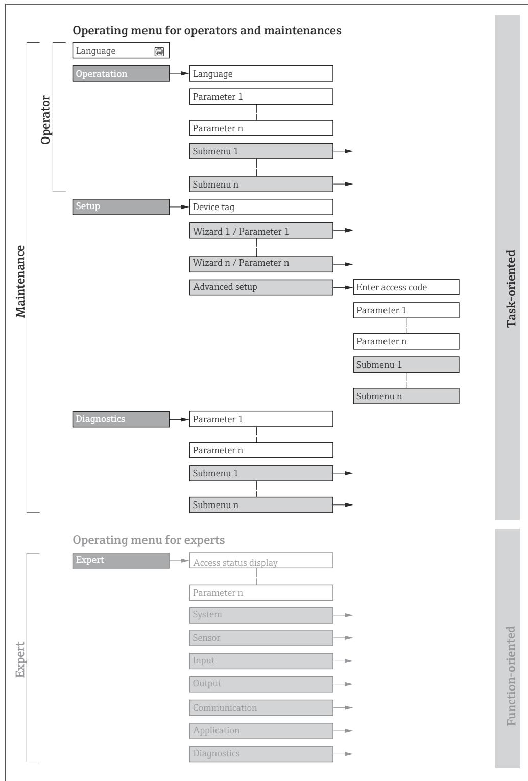
29 Estrutura esquemática do menu de operação
