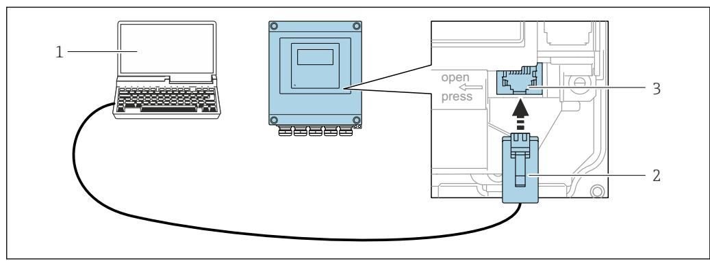
**Fig. 34 Conexão através de Interface de operação (CDI-RJ45)**
