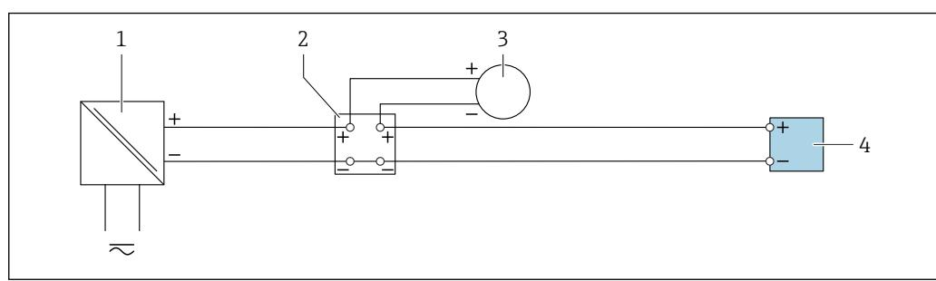
27 Exemplo de conexão para entrada em corrente de 4 a 20 mA
