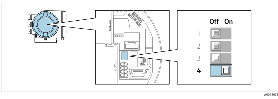
Para comutar o endereçamento de software para o endereçamento de hardware:
