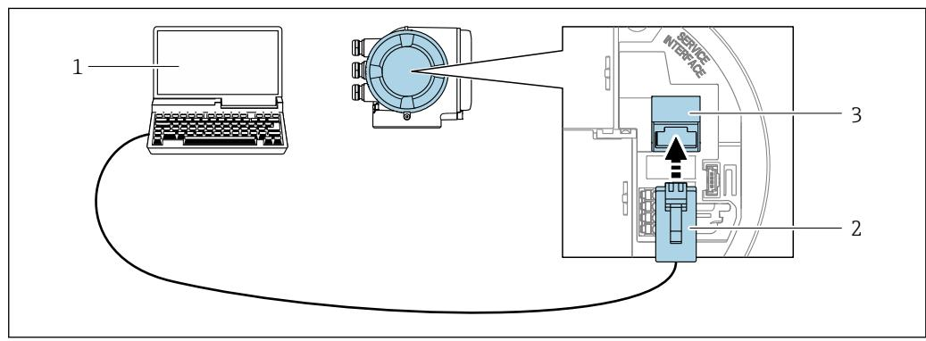
**Fig. 35 Conexão através de Interface de operação (CDI-RJ45)**
