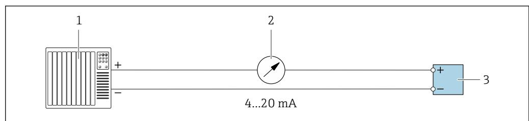
■ 20 Exemplo de conexão para saída de corrente 4-20 mA (ativa)
