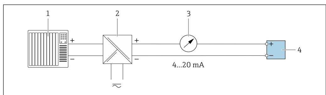
■ 21 Exemplo de conexão para saída de corrente 4-20 mA (passiva)
