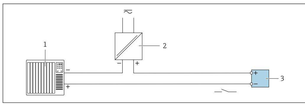
26 Exemplo de conexão para saída a relé (passiva)
