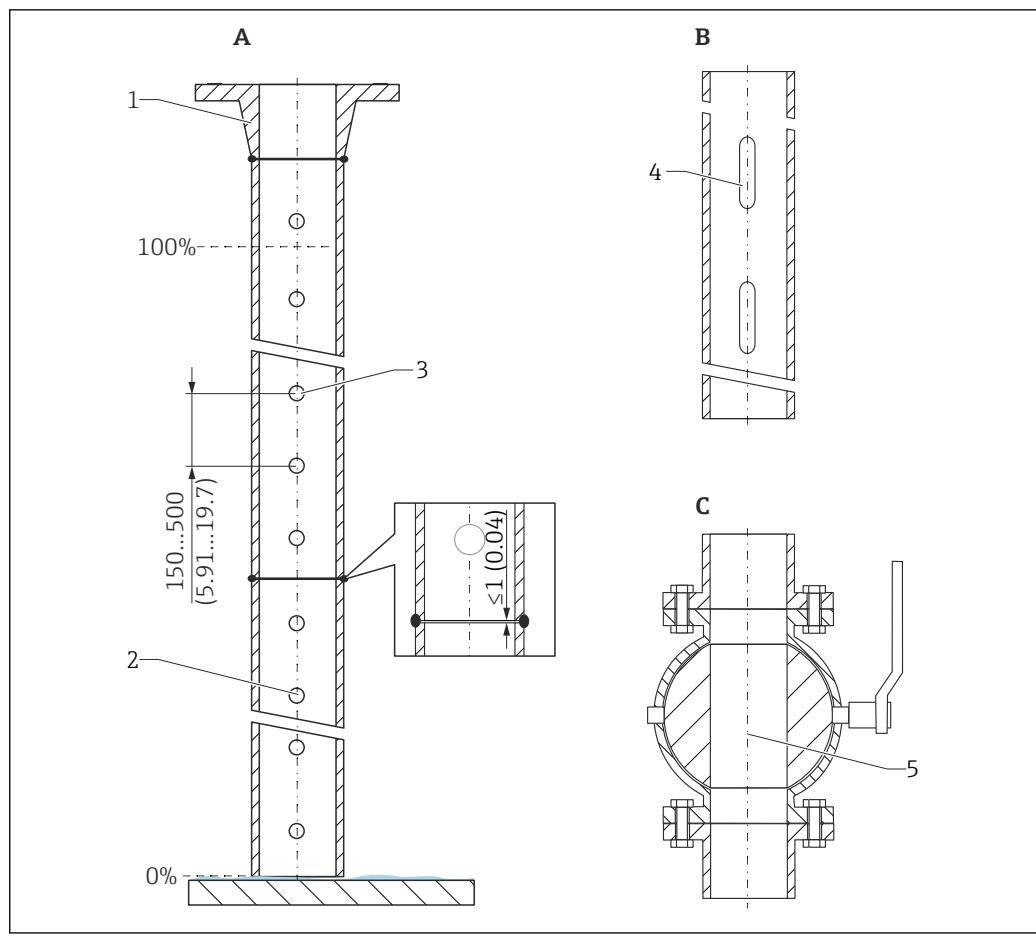
図 10 内筒管の構造例。測定単位 mm (in)
