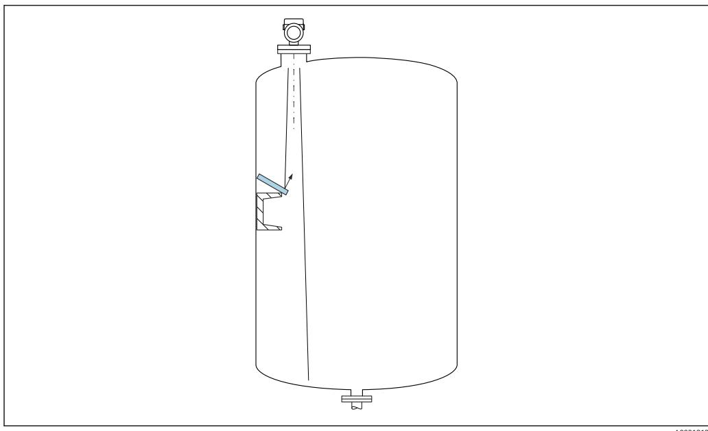
レーダー信号を散乱させるために斜めに設置された金属製偏向板が、不要反射の防止に役立ちます。
