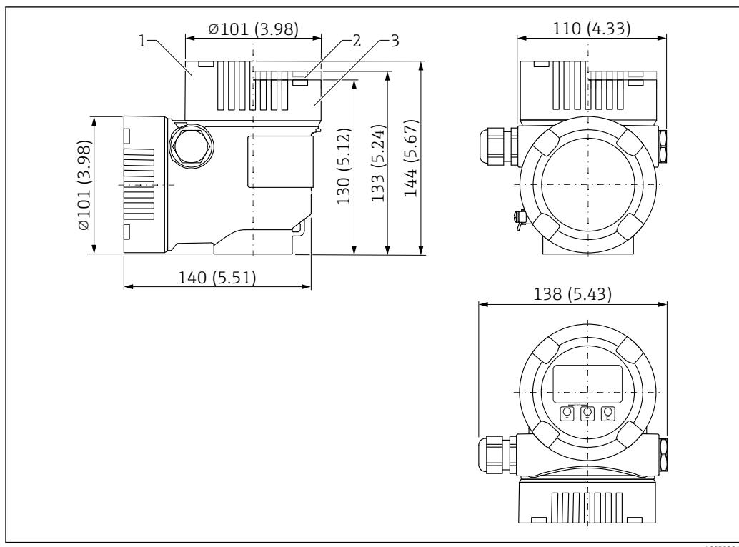
図 55 デュアル端子箱部、L字型の寸法。測定単位 mm (in)
