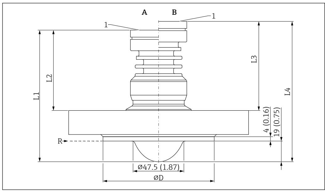
図 58 PTFE 外装付フラッシュマウントアンテナ (50 mm (2 in)、フランジ付き) の寸法。測定単位 mm (in)
