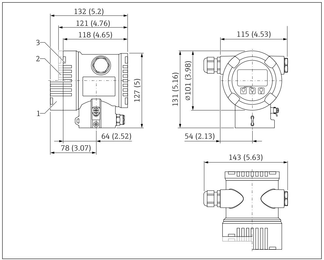
図 54 デュアル端子箱部の寸法。測定単位 mm (in)
