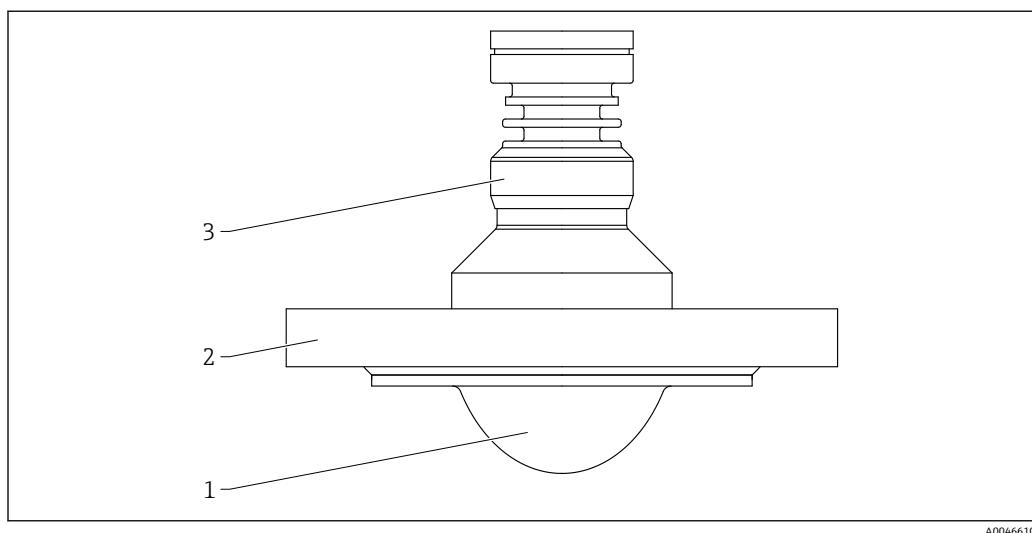
**図 63 材質；PTFE 外装付フラッシュマウントアンテナ、80 mm (3 in)、フランジ付き**
