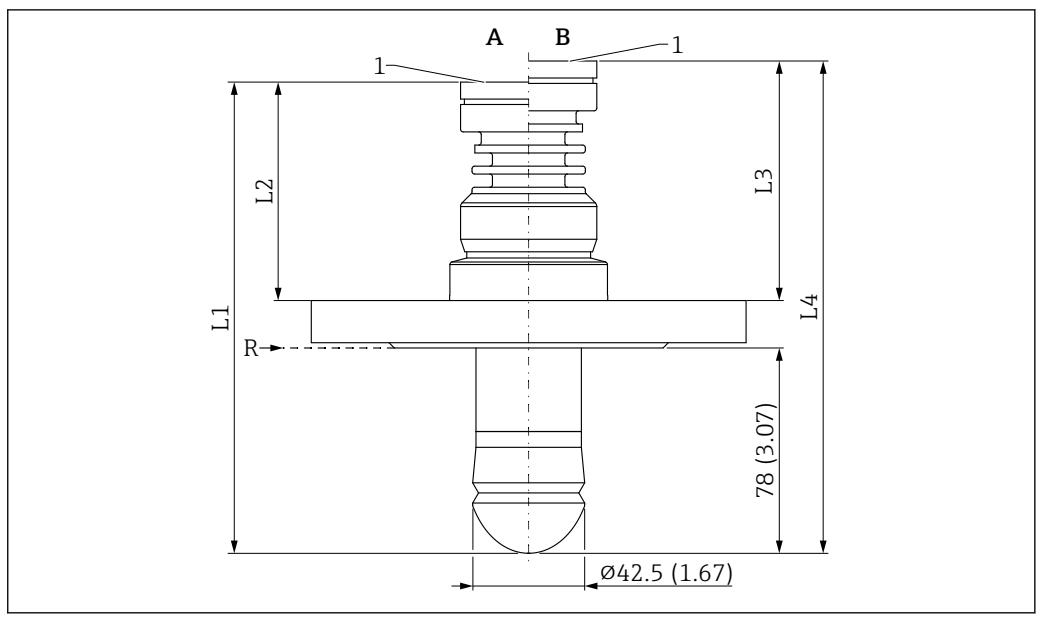
図 57 フランジプロセス接続の寸法。測定単位 mm (in)
