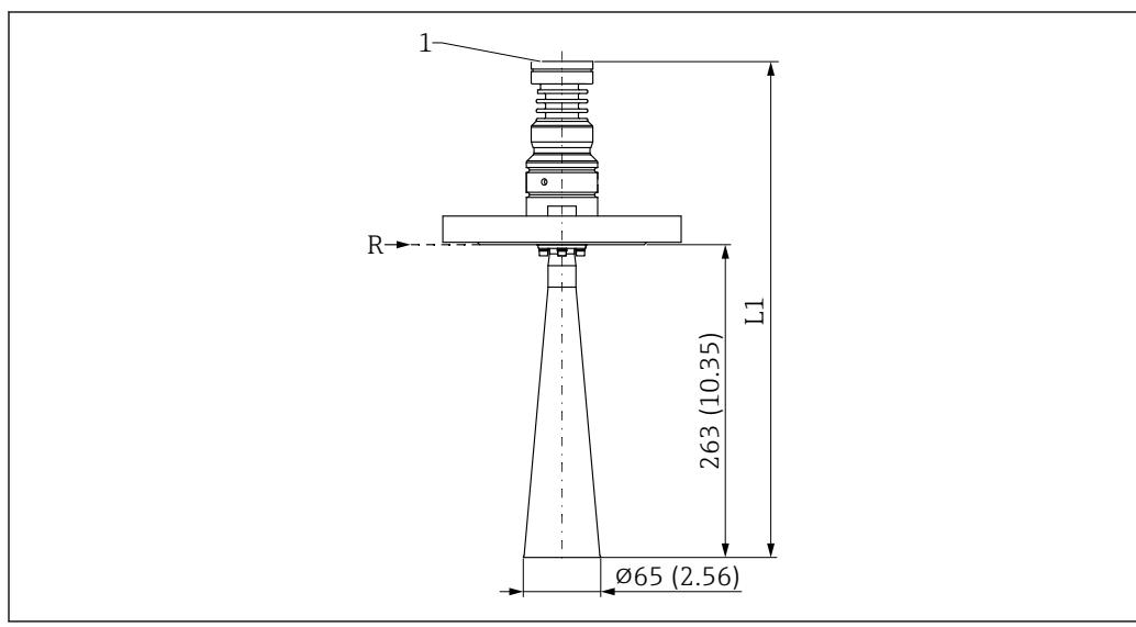
図 56 DN65 ホーンアンテナ - フランジプロセス接続の寸法。測定単位 mm (in)
