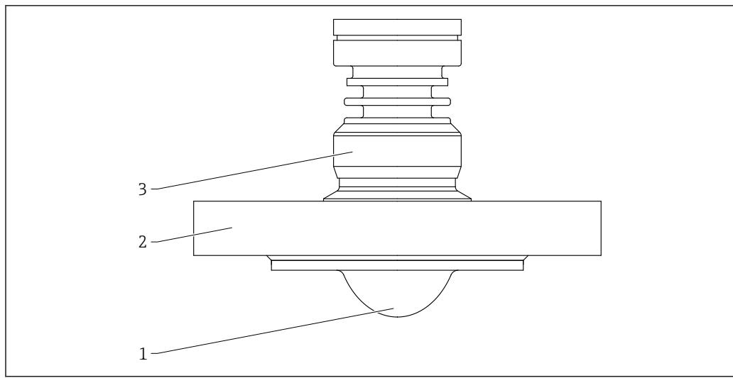
**図 62 材質；PTFE 外装付フラッシュマウントアンテナ、50 mm (2 in)、フランジ付き**
