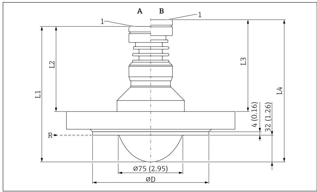
図 59 PTFE 外装付フラッシュマウントアンテナ (80 mm (3 in)、フランジ付き) の寸法。測定単位 mm (in)
