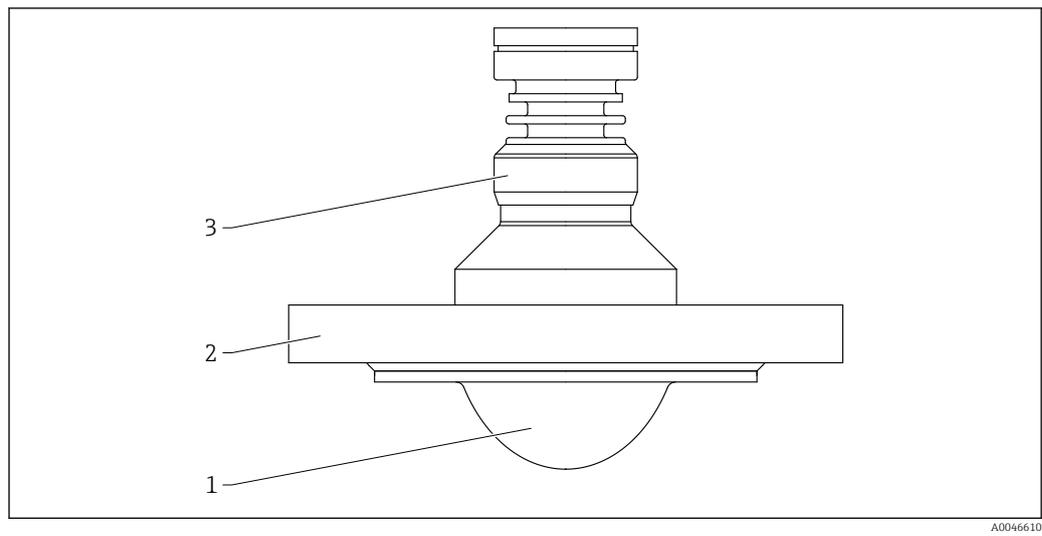
63 Material: antena, revestida com montagem flush, PTFE, 80 mm (3 in), com flange
