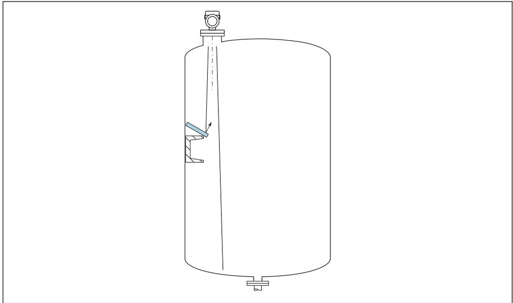
As placas do defletor de metal instaladas em um ângulo para espalhar os sinais de radar ajudam a evitar ecos de interferência.
