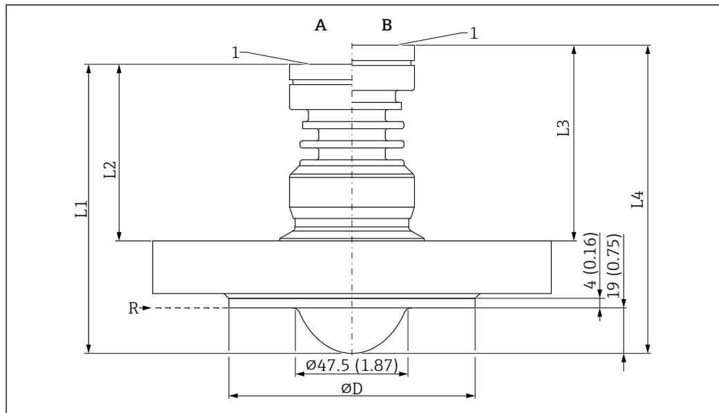
58 Dimensões da antena, revestida com montagem flush, PTFE, 50 mm (2 in), com flange. Unidade de medida mm (in)
