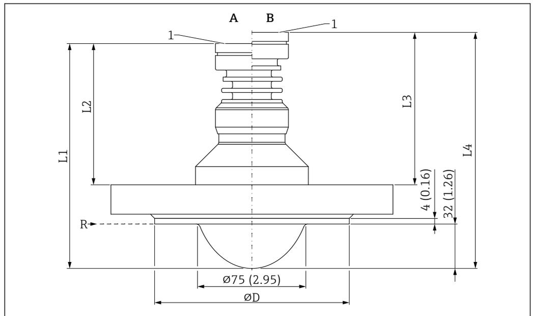
59 Dimensões da antena, revestida com montagem flush, PTFE, 80 mm (3 in), com flange. Unidade de medida mm (in)
