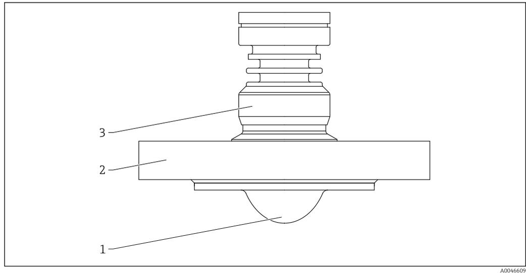
62 Material: antena, revestida com montagem flush, PTFE, 50 mm (2 in), com flange
