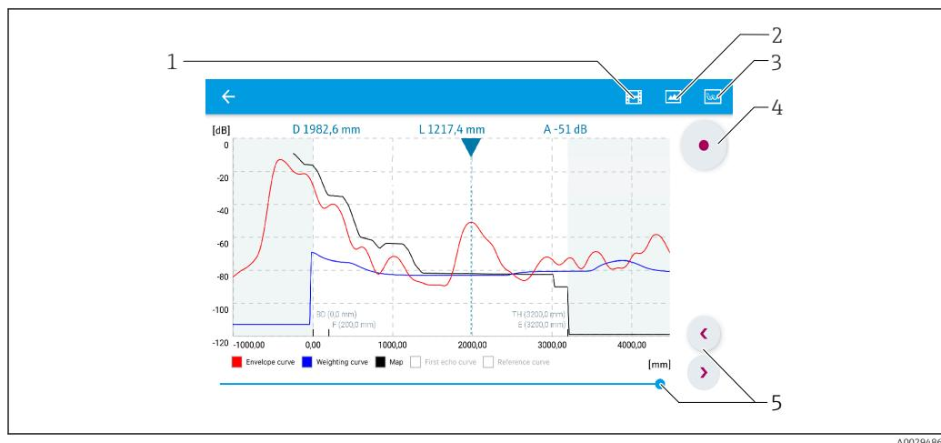
29 Display de curva envelope (amostra) em SmartBlue para Android
