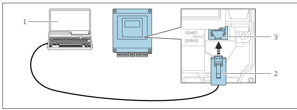
**■ 35 Conexão através de Interface de operação (CDI-RJ45)**
