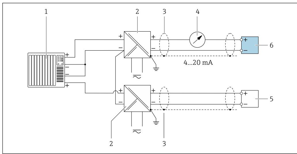
**Fig. 19 Exemplo de conexão entrada HART com um ponto comum negativo (passivo)**
