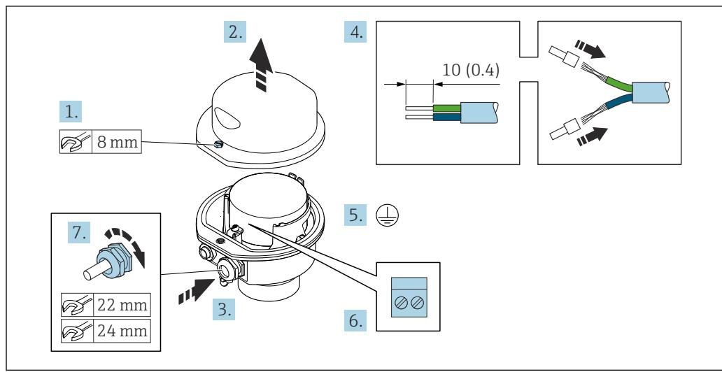
1. Libere o parafuso de fixação da tampa do invólucro.
