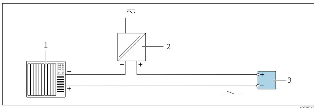
Fig. 26 Exemplo de conexão para saída a relé (passiva)
