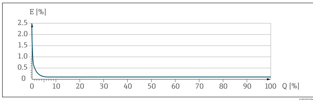
$E$  Erro máximo medido em % o.r. (exemplo) $Q$  Taxa de vazão em um % do valor de fundo de escala máxima**16.7 Instalação**
