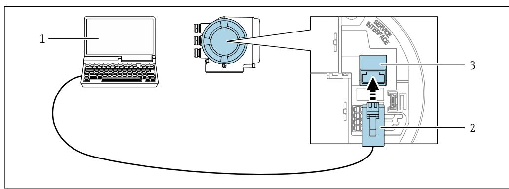
**■ 36 Conexão através de Interface de operação (CDI-RJ45)**
