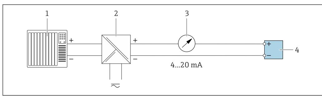
**Fig. 21 Exemplo de conexão para saída de corrente 4-20 mA (passiva)**
