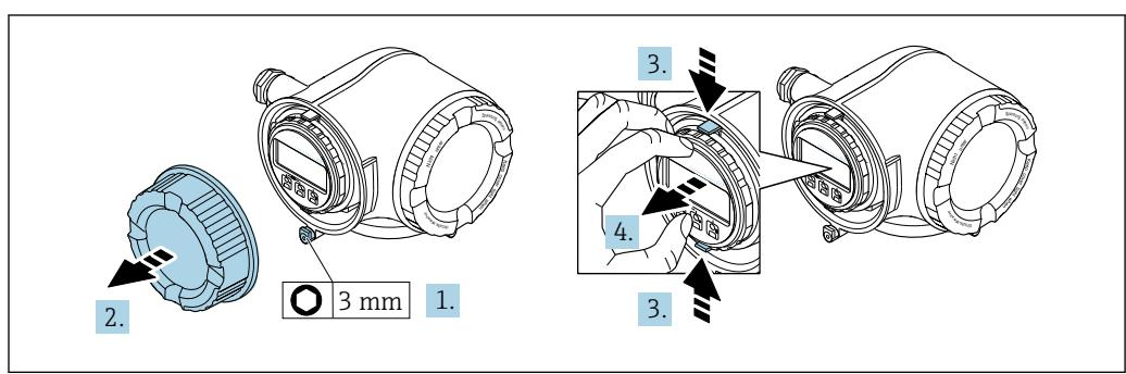
1. Solte a braçadeira de fixação da tampa do compartimento de conexão.
