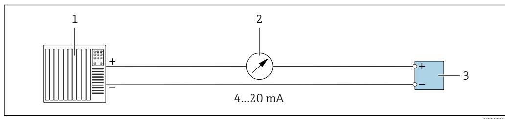
**Fig. 20 Exemplo de conexão para saída de corrente 4-20 mA (ativa)**
