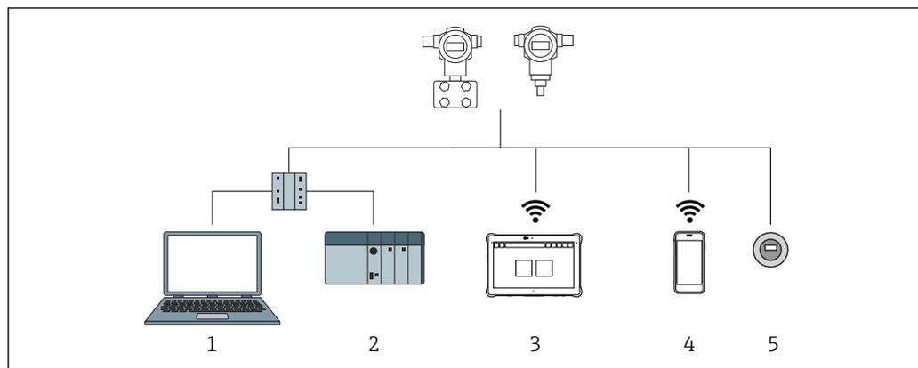
**i** 16 Opções para operação remota através do protocolo PROFINET
