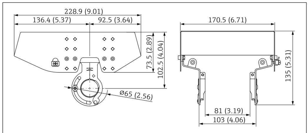
Fig. 23 Dimensões. Unidade de medida mm (in)
