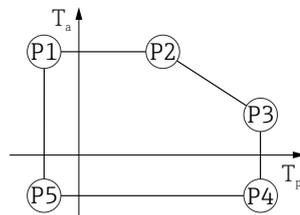
**32** Invólucro plástico; temperatura do processo -20 para +150 °C (-4 para +302 °F)
