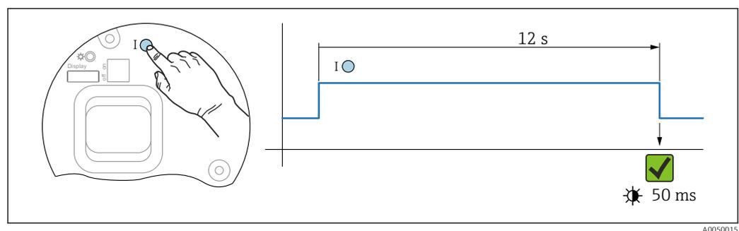
Fig. 22 Sequência - configuração de fábrica
