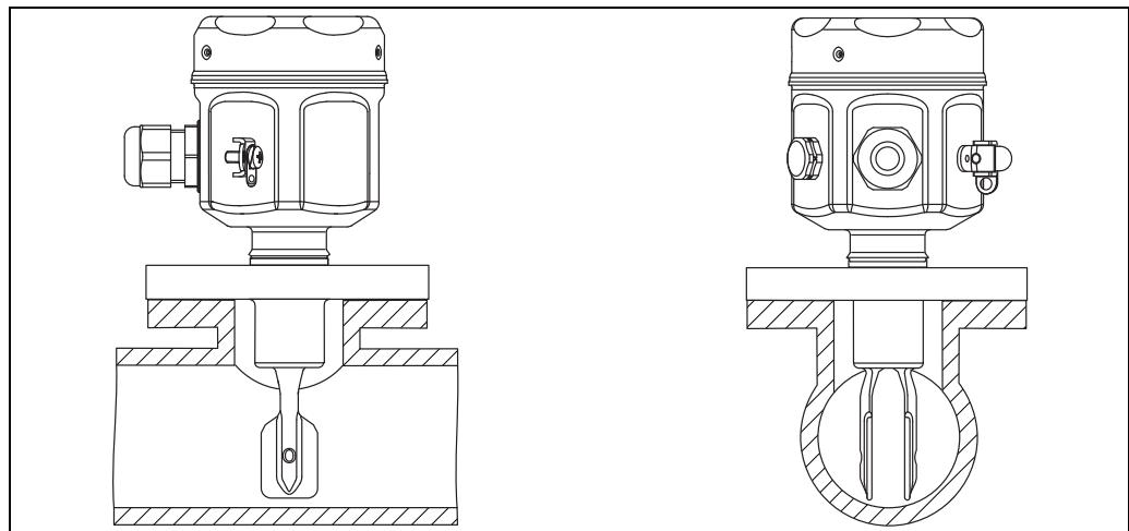
**При наличии серьезной динамической нагрузки необходимо обеспечить опору прибора.**
