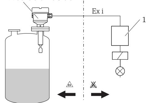
1 = коммутационное устройство, ПЛК, изолирующий усилитель, сегментный соединитель
