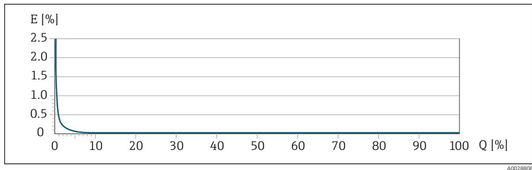
E Errore di misura massimo in % v.i. (esempio con PremiumCal)
