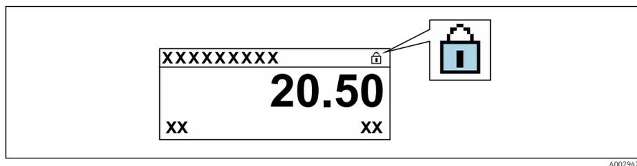
2. Impostando il microinterruttore di protezione scrittura (WP) sul modulo dell'elettronica principale in posizione **OFF** (impostazione di fabbrica), si disattiva la protezione scrittura hardware.
