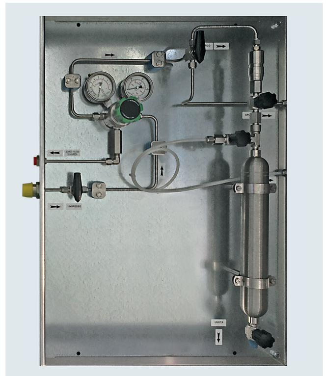
Tragbare Spezialausrüstung für die Probenahme der Flüssigkeit vor Ort aus der Diagnosekammer
