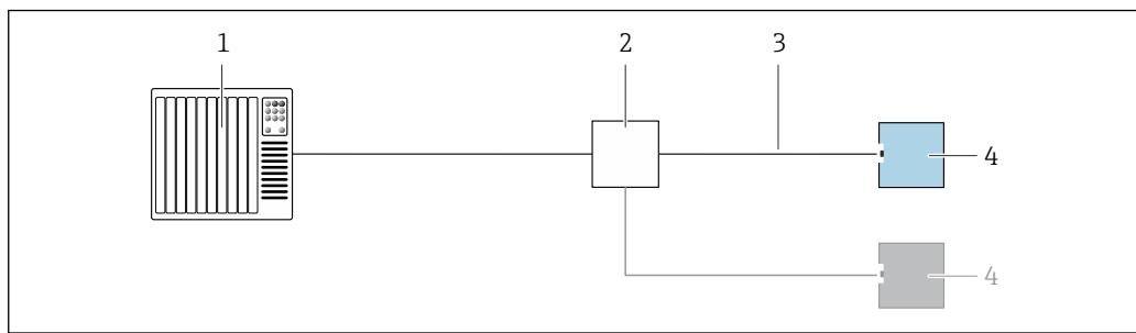
图 7 接线示例：具有 Ethernet-APL 功能的 PROFINET
