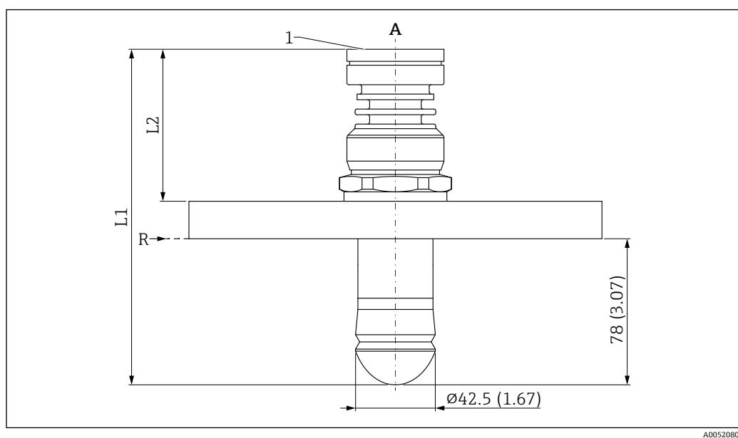
图 31 水滴型天线 (50 mm (2 in)口径) 的外形尺寸示意图；UNI 法兰过程连接。测量单位 mm (in)
