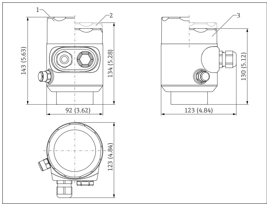
图 22 316L 单腔室外壳（卫生型）的外形尺寸示意图。测量单位 mm (in)
