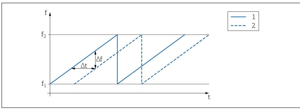
图 2 FMCW 原理：调频结果
