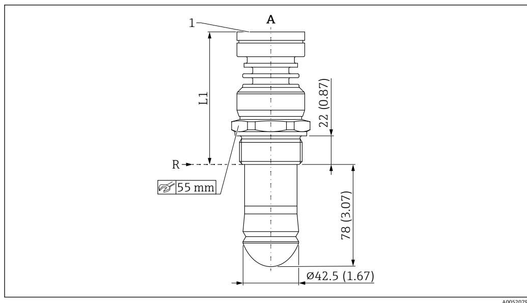
图 30 水滴型天线 (50 mm (2 in)口径) 的外形尺寸示意图；螺纹过程连接。测量单位 mm (in)
