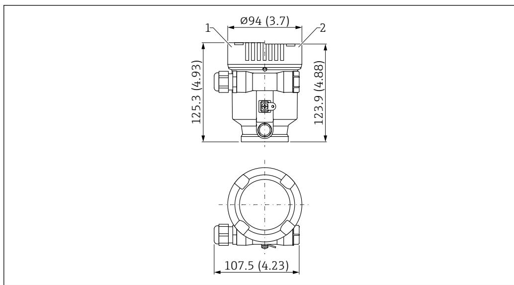
图 20 单腔室塑料 (PBT) 外壳的外形尺寸示意图。测量单位 mm (in)
