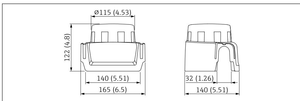
图 41 外形尺寸示意图。测量单位 mm (in)
