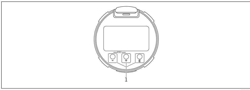
图 38 图形显示单元，带光敏按键 (1)
