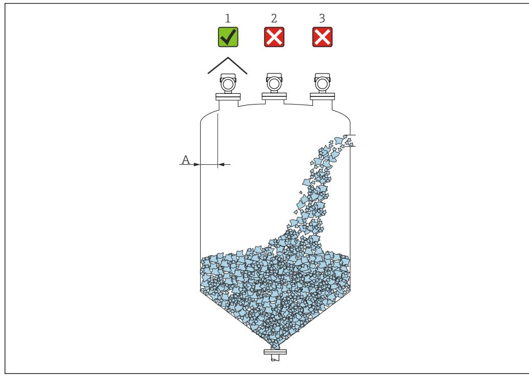
A 罐壁与安装短管外壁间的推荐安装距离：约为罐体直径的 1/6。仪表安装位置与罐壁间的距离不得小于 20 cm (7.87 in)。
