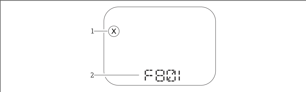
图 19 段码显示屏，无按键
