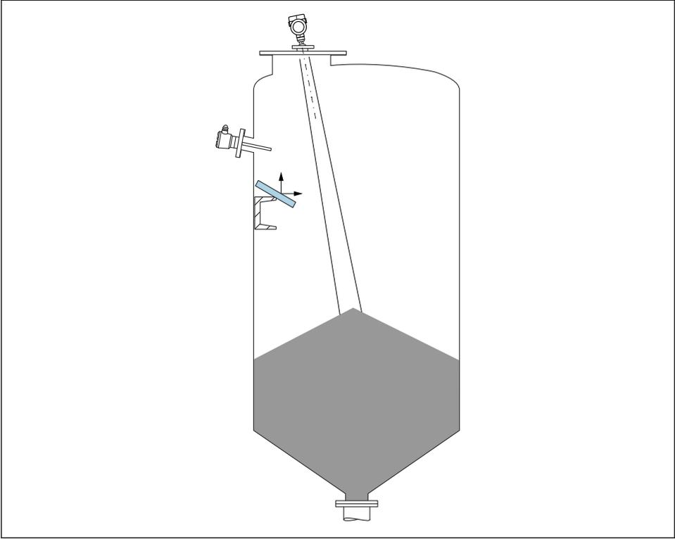
倾斜安装的金属反射板能够散射雷达波信号，有助于减少干扰回波。
