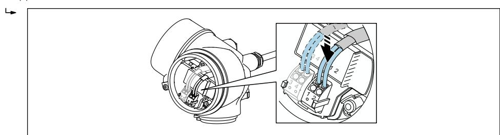
6. При использовании экранированных кабелей: подсоедините экран кабеля к клемме заземления.
