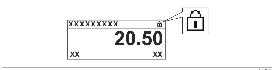
Если аппаратная защита от записи деактивирована: опции в параметре параметр **Статус блокировки** не отображаются. Прекращается отображение символа
