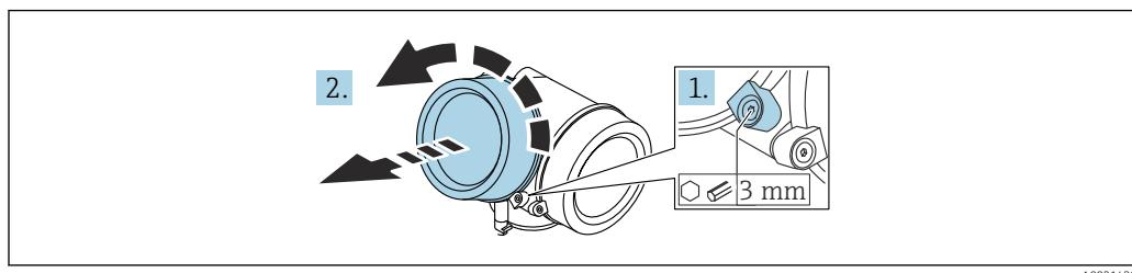
1. Шестигранным ключом (3 мм) ослабьте винт крепежного зажима крышки отсека электроники и поверните зажим 90 град против часовой стрелки.
