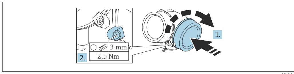
1. Заверните крышку клеммного отсека.
