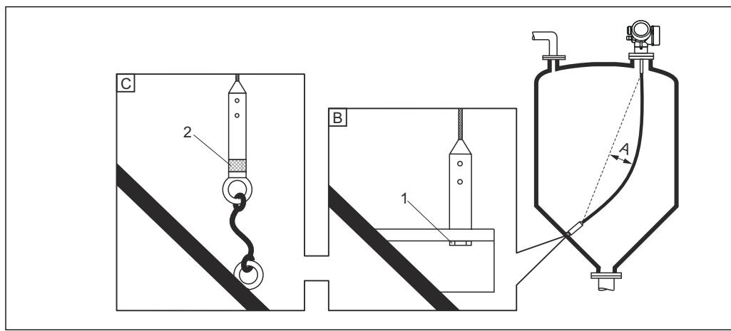
A Провисание троса:  $\geq 10 \text{ мм}/(1 \text{ м длины зонда})$  ( $0,12 \text{ дюйма}/(1 \text{ фут длины зонда})$ )
