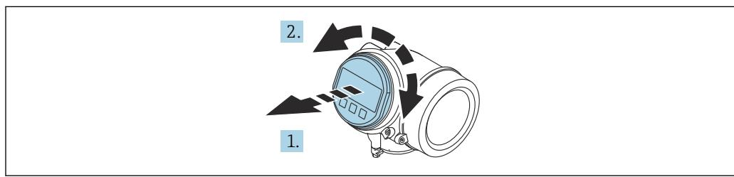
1. Плавным вращательным движением извлеките дисплей.
