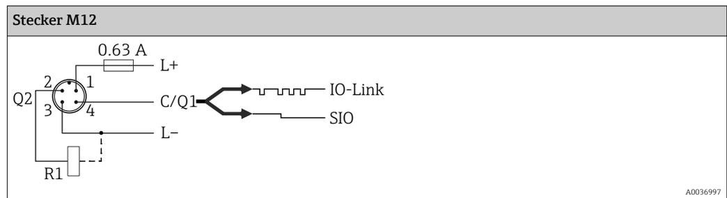
1 x PNP Schaltausgang R1 mit zusätzlichem Analogausgang 4...20 mA (aktiv)
