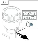
► Blocco della custodia, solo per custodia in acciaio inox o alluminio. Non per custodia in plastica e igienica.
