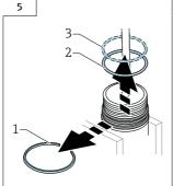
► Sostituire O-ring (2) e anello a scatto (1). Per la custodia in plastica e igienica, sostituire anche l'anello di sicurezza (3).
