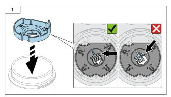
► Fissare il cavo di collegamento al sensore. Far scorrere l'isolamento in plastica sopra il cavo di collegamento. Ruotare con attenzione la custodia, finché il profilo non è posizionato nell'incameratura. Continuare quindi a girare la custodia con cautela, finché l'armatura del sensore non si arresta.
