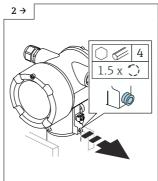
Blocco della custodia, solo per custodia in acciaio inox o alluminio. Non per custodia in plastica e igienica.
