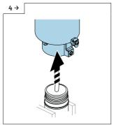
► Togliere con cautela la custodia dall'armatura del sensore, facendo attenzione a non danneggiare il cavo del sensore.
