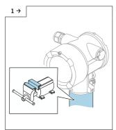
Proteggere armatura del sensore e custodia da eventuali danni. Utilizzare una morsa a vite con ganasce.
