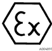
Рис. 3. Ярлык АТЕХ для использования во взрывоопасных зонах
