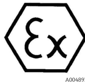
Рис. 6. Ярлык АТЕХ для использования во взрывоопасных зонах
