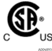
Рис. 5. Ярлык, указывающий на допуск оборудования для использования во взрывоопасных зонах в США и в Канаде
