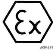
그림 3. 위험 지역 사용이 가능함을 보여주는 ATEX 라벨
