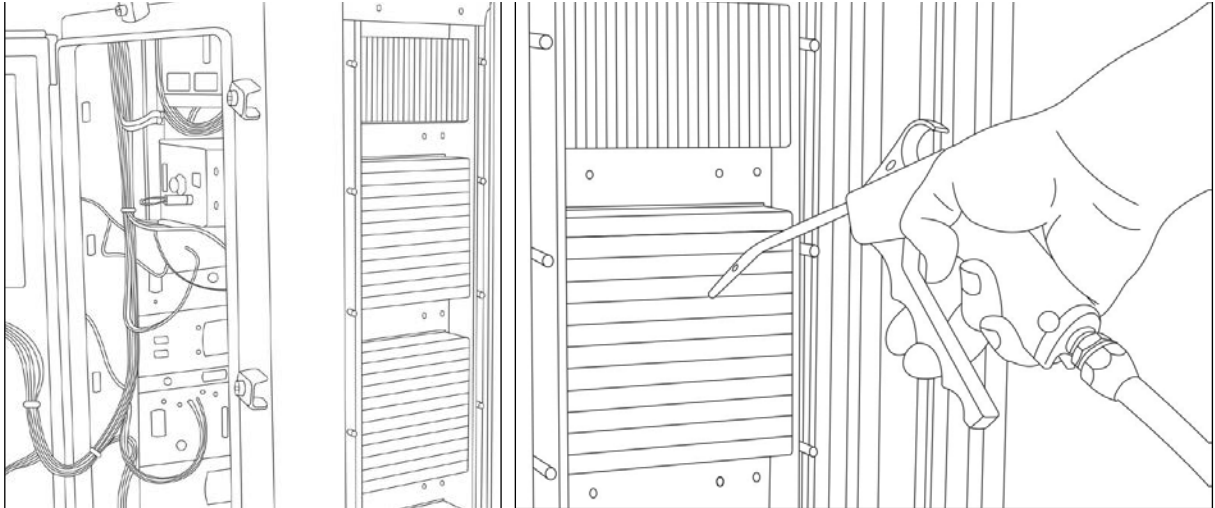
그림 111. 압축 공기 또는 물을 이용한 방열판 청소
