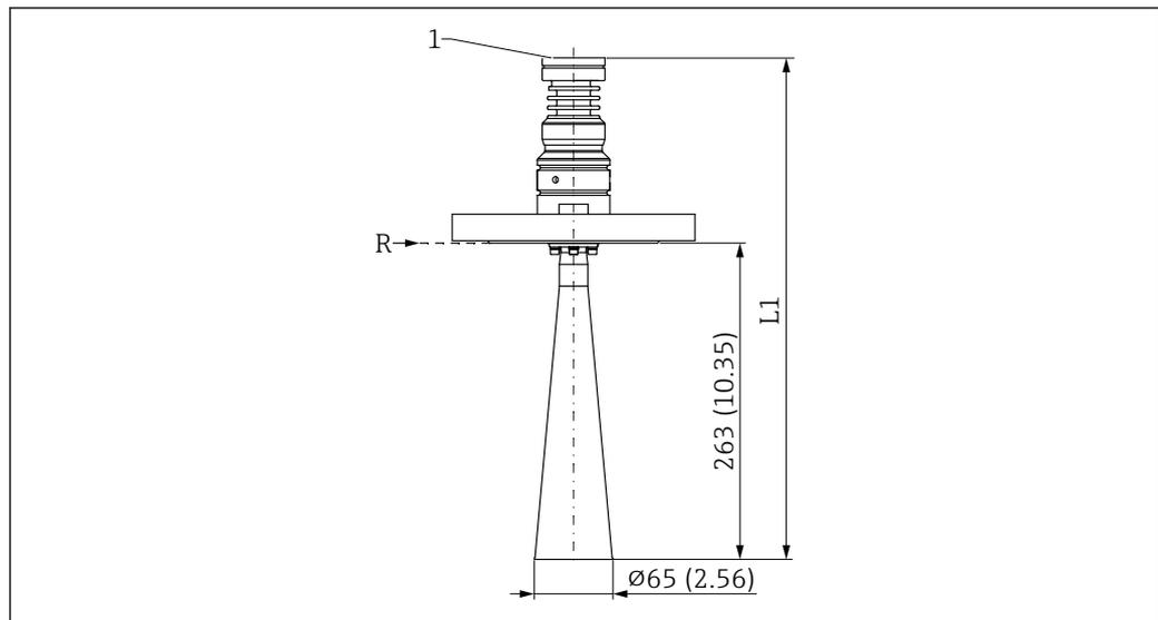
57 Abmessungen DN65 Hornantenne - Prozessanschluss Flansch. Maßeinheit mm (in)
