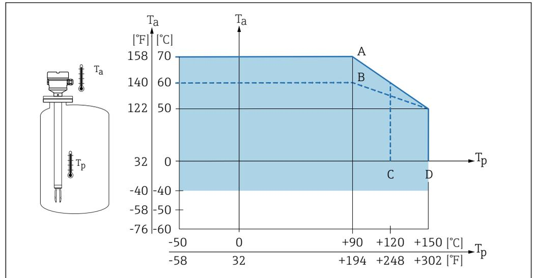
49 Température ambiante admissible  $T_a$  au boîtier en fonction de la température de process  $T_p$  dans la cuve :
