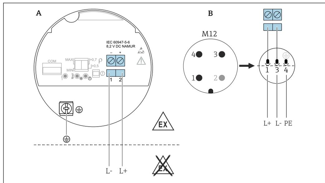
27 NAMUR 2 fils  $\geq 2,2 \text{ mA} / \leq 1,0 \text{ mA}$ , électronique FEL68
