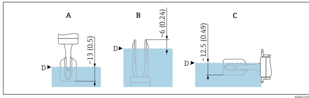
**5** Points de détection typiques, fourche vibrante revêtue de plastique (ECTFE, PFA). Unité de mesure mm (in)
