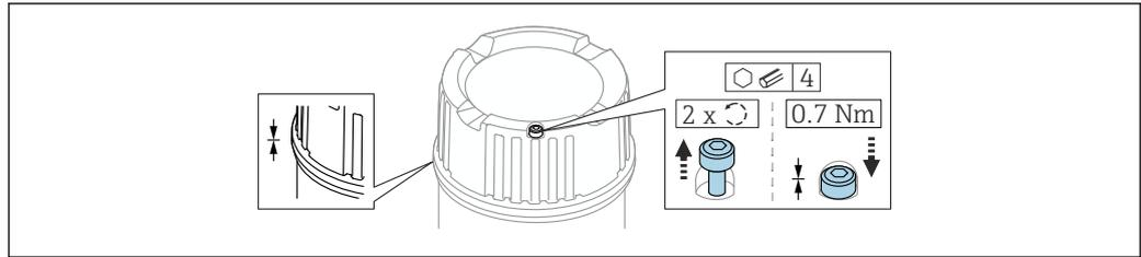
15 Couverture avec vis de fixation
