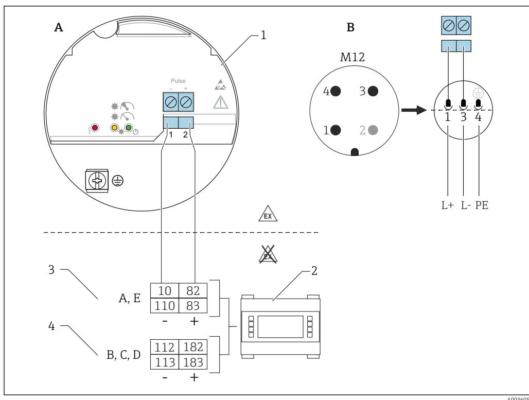
■ 17 Схема подключения: соединение электронной вставки FEL60D с электронным преобразователем FML621
