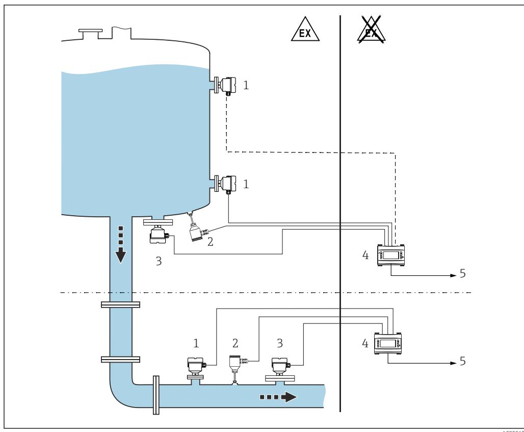
■ 18 Измерение плотности в сочетании с электронным преобразователем Density Computer FML621
