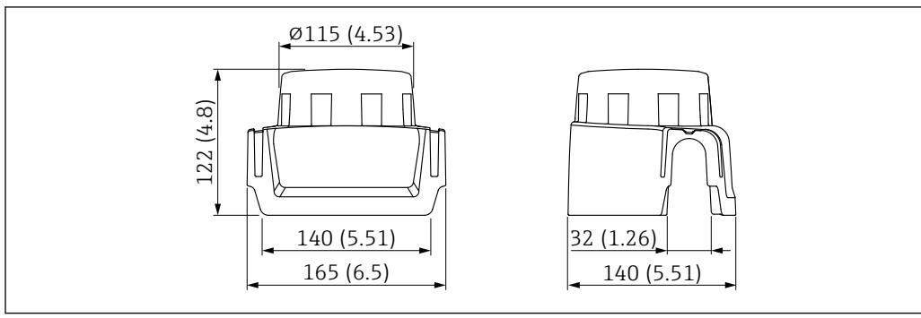
■ 22 Защитный козырек для однокамерного корпуса, алюминий или 316L. Единица измерения мм (дюйм)
