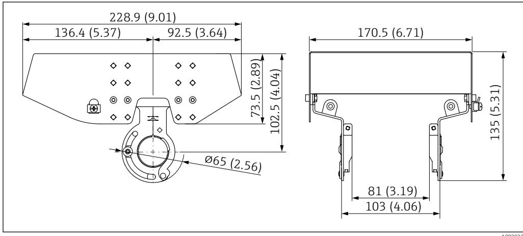
■ 21 Защитный козырек для двухкамерного алюминиевого корпуса. Единица измерения мм (дюйм)
