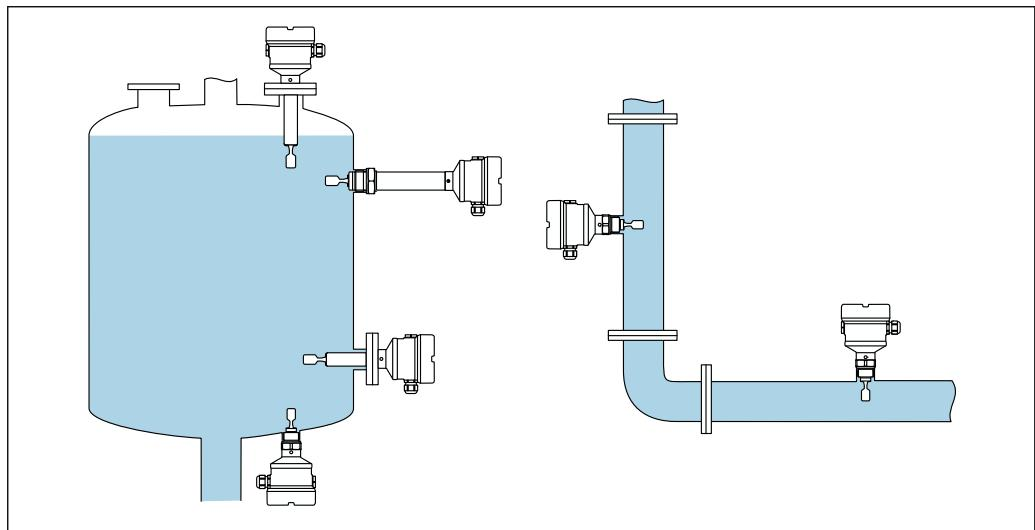
■ 3 Примеры монтажа в резервуаре, баке или трубопроводе
