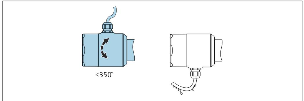
15 Caja sin tornillo de bloqueo con circuito de goteo
