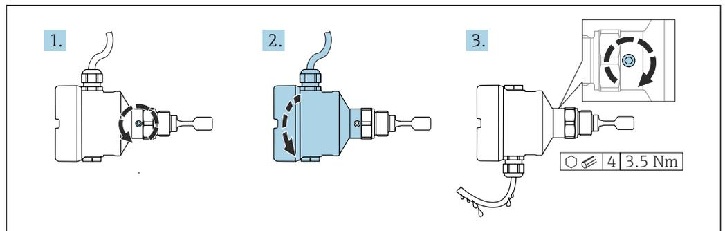
16 Caja con tornillo de bloqueo externo y circuito de goteo
