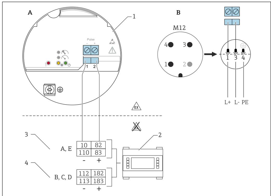
18 Diagrama de conexiones: conexión del módulo del sistema electrónico FEL60D al calculador de densidad FML621
