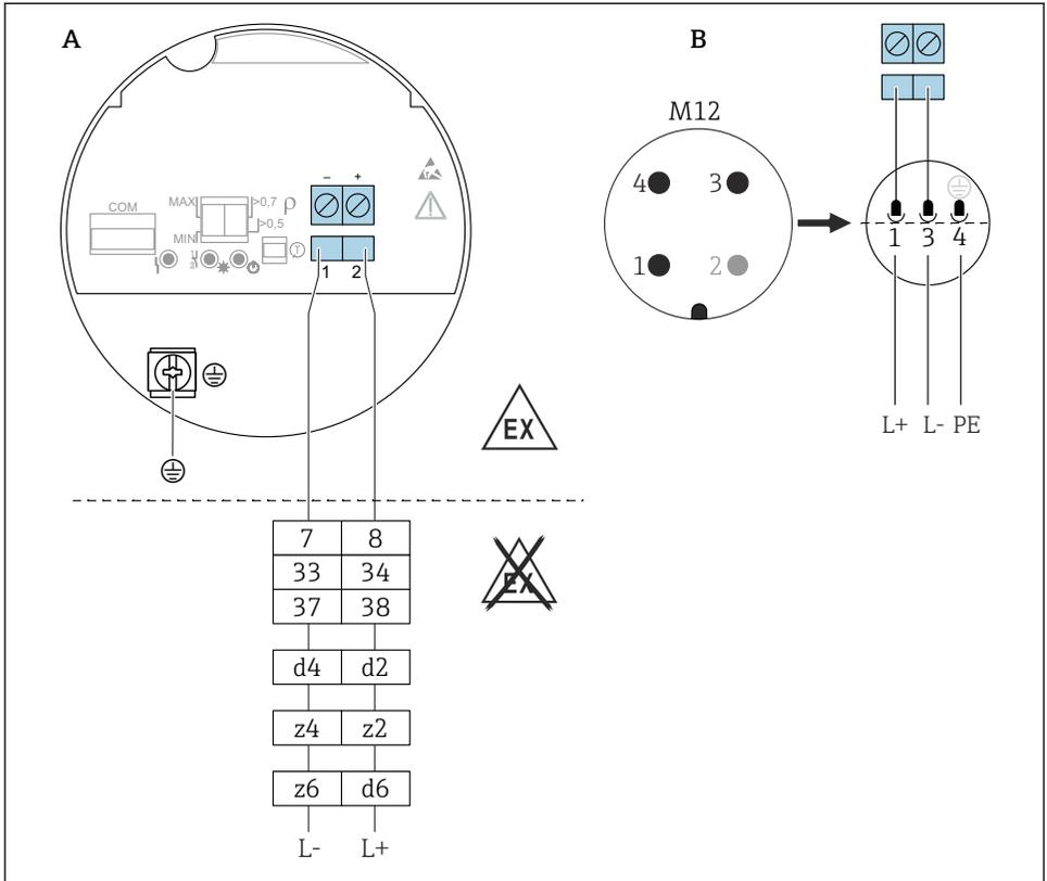
23 Salida PFM, módulo de la electrónica FEL67
