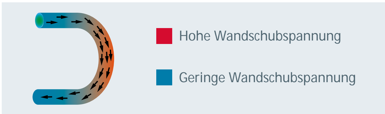
Simulation der Wandschubspannung in einem Rohrbogen
