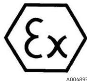
Figure 6. Label ATEX pour l'utilisation en zone explosible
