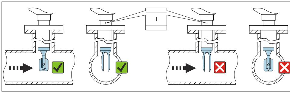
图 10 安装在管道中 (注意叉体安装位置和标记)
