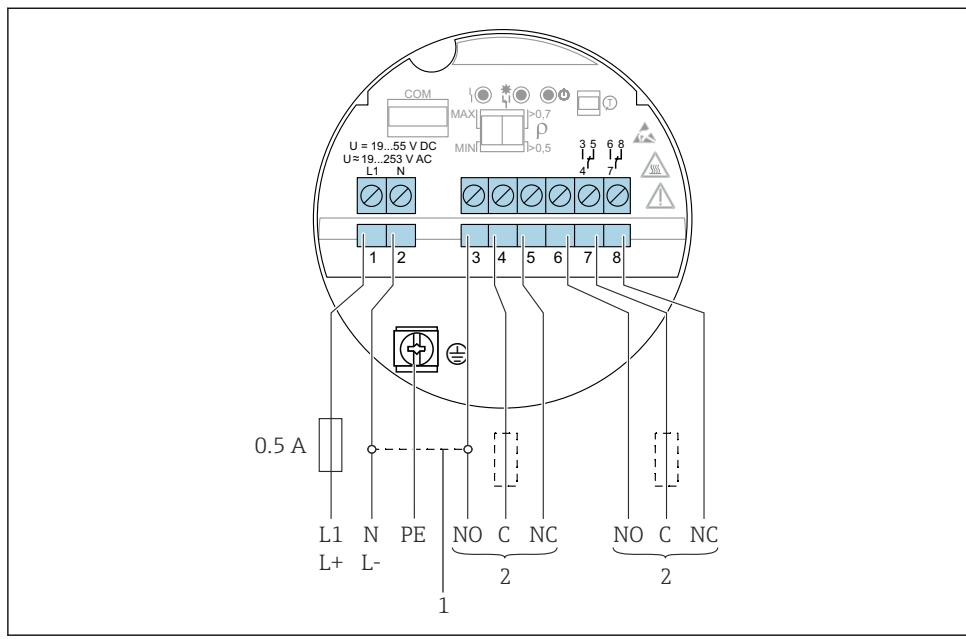
图 18 电子插件 FEL64：通用电流连接型，带继电器输出
