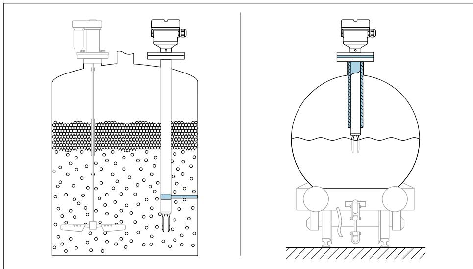
图 8 实例：存在动态负载时，应支撑设备
