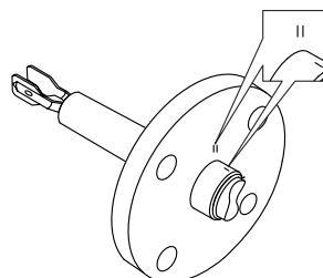
图 9 参照标记水平安装在罐体中时的叉体位置
