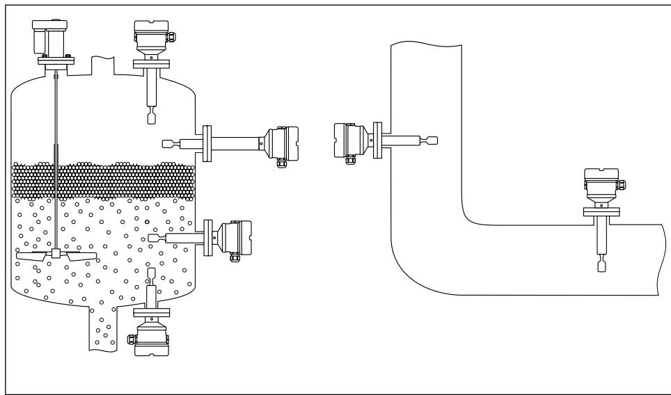
图 1 安装实例：安装在容器、罐体或管道中
