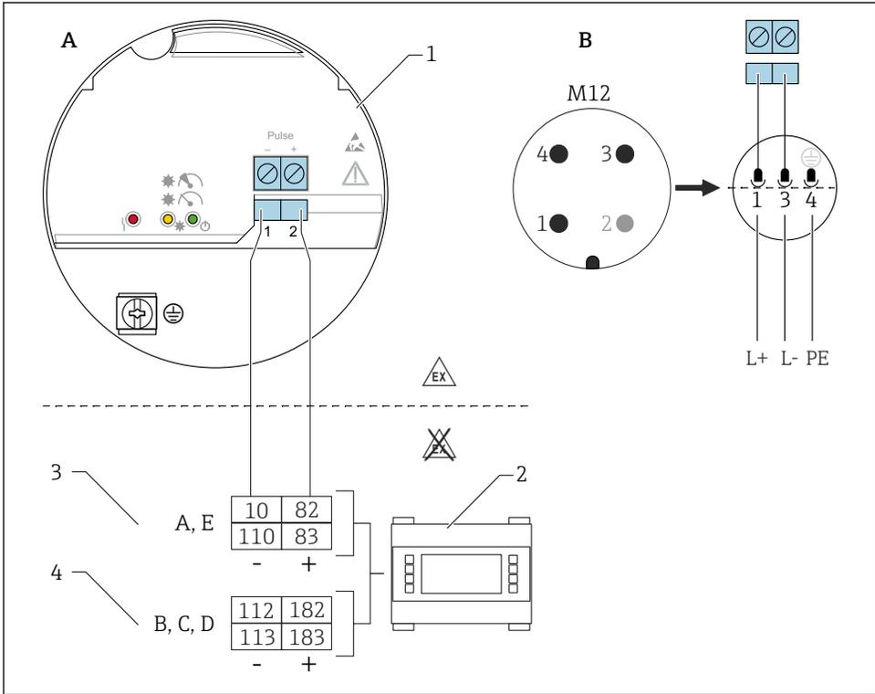
16 Schéma de raccordement : raccordement de l'électronique FEL60D au calculateur de densité FML621
