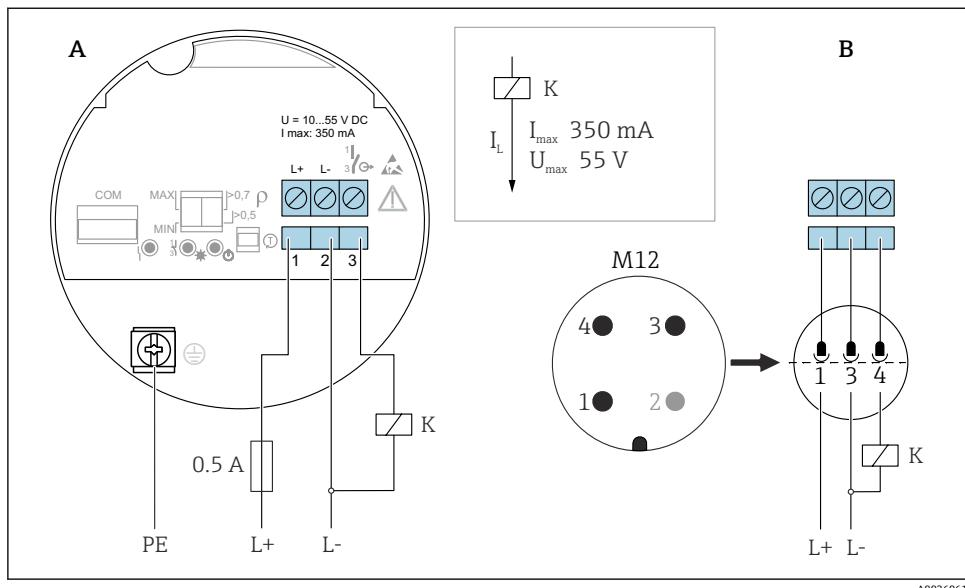
图 17 电子插件 FEL62：三线制连接，直流 DC-PNP 型
