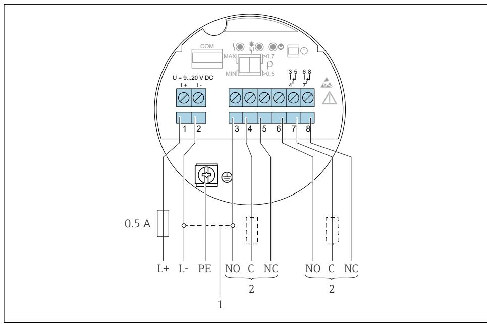
图 21 电子插件 FEL64 DC: 直流连接型, 带继电器输出
