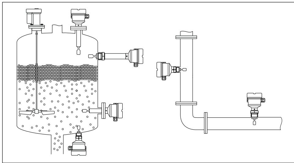
图 1 安装实例：安装在容器、罐体或管道中
