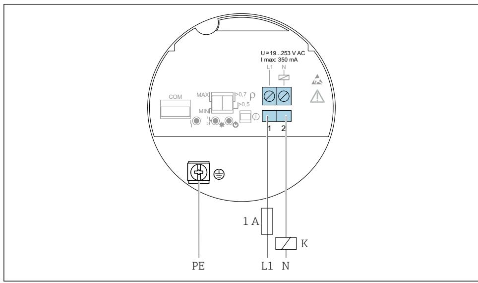
图 14 FEL61 电子插件: 两线制连接, 交流 AC 型
