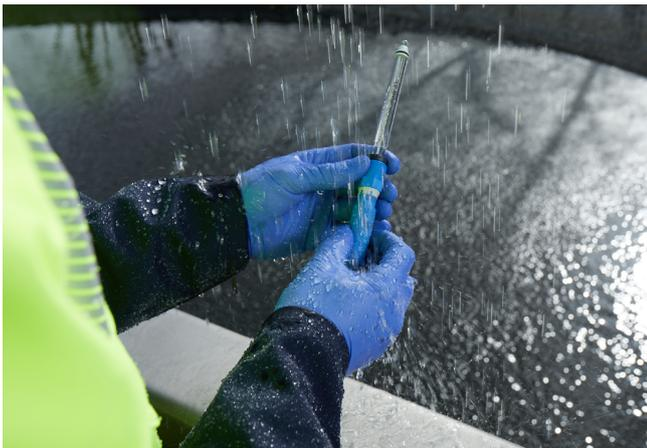
La connexion du capteur Memosens est insensible à l'eau, à l'humidité et à la poussière
