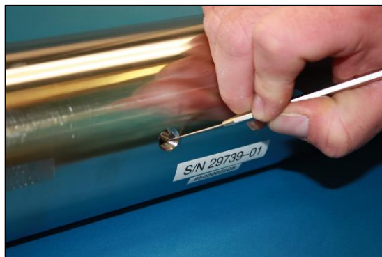
Fig 33. Remoção do excesso de fita de vedação da flange
