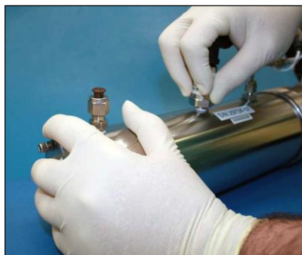
Fig 36. Substituição do sensor de pressão
