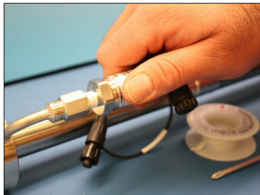
Fig 42. Substituição do sensor de pressão.
