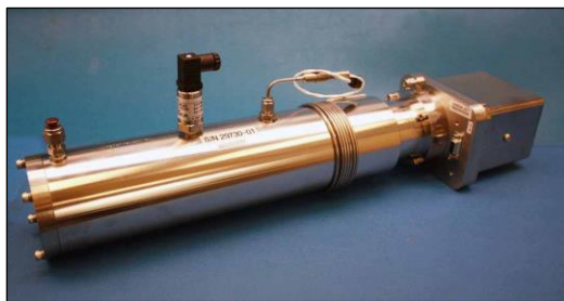
Fig 37. Novo sensor de pressão instalado.
