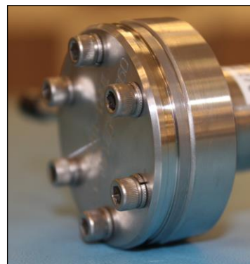
Figuras 27 e 28. Marca no espelho de aço inoxidável: espelho com X gravado (esquerda), espelho com borda ranhurada (direita)
