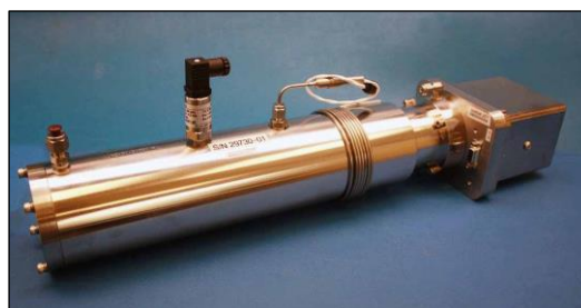
Fig 31. Célula de medição removida com o sensor de pressão orientado para cima
