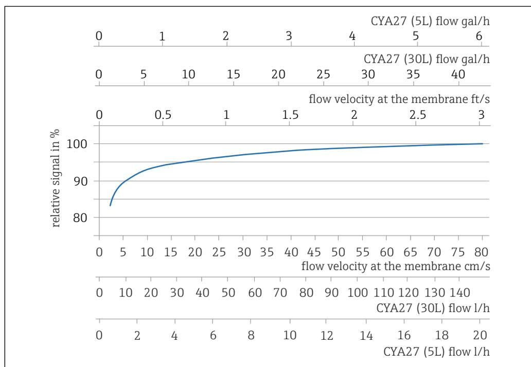
图 2 电极斜率与覆膜处流速/安装支架中流量的相互关系
