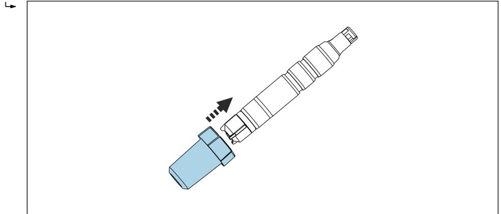
图 10 将保护帽小心地旋转安装在覆膜帽上。
