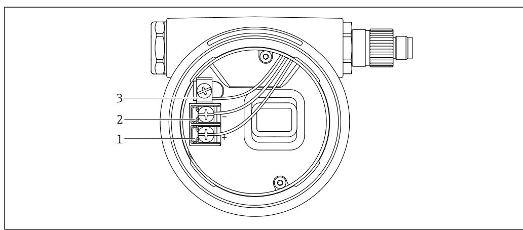
図 4 端子部の接続端子と接地端子
