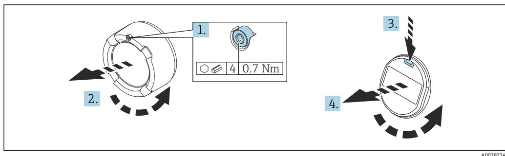
1. (取り付けている場合) 六角レンチを使用して、表示部カバーのカバーロックのネジを緩めます。
