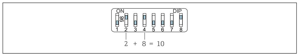
図 12 ハードウェアアドレス指定の例：スイッチ 8 を「ON」位置にし、スイッチ 1～7 にアドレスを定義します。
