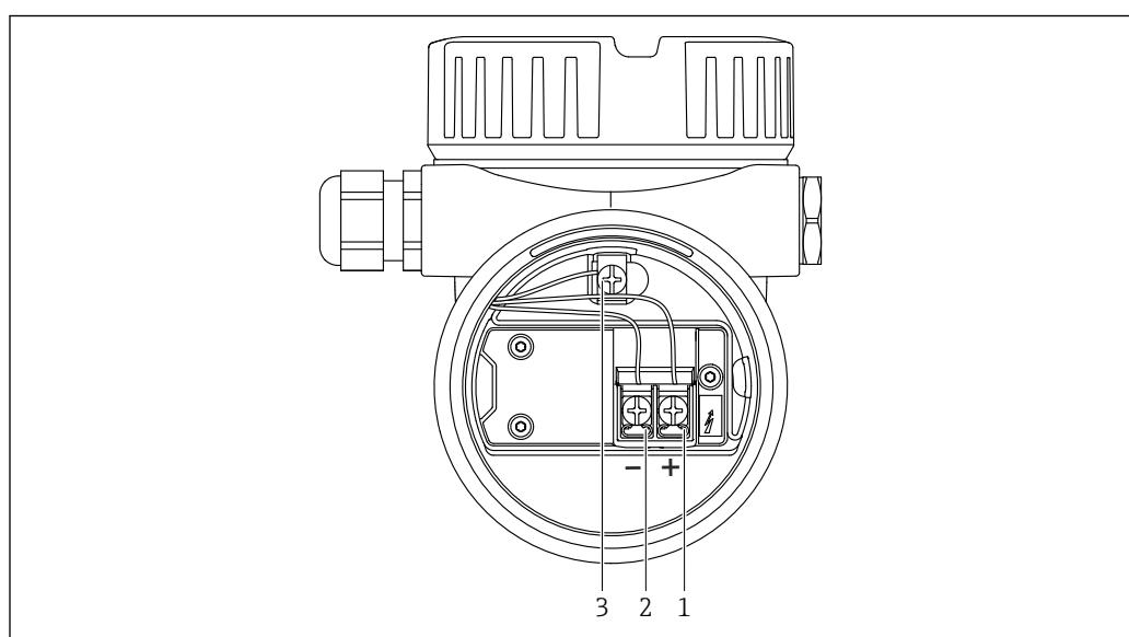
図 9 端子部の接続端子と接地端子
