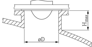
**i** これより長いノズルを使用した場合、測定性能が低下します
