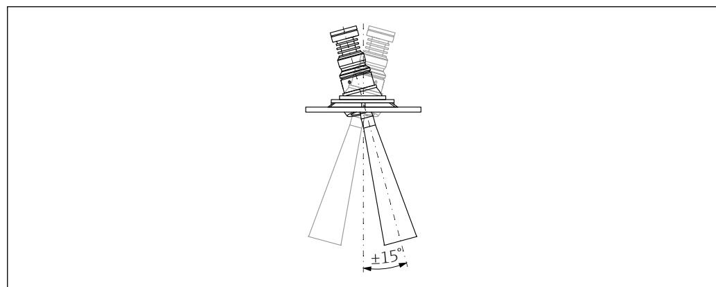
図 2 角度調節器付きホーンアンテナ
