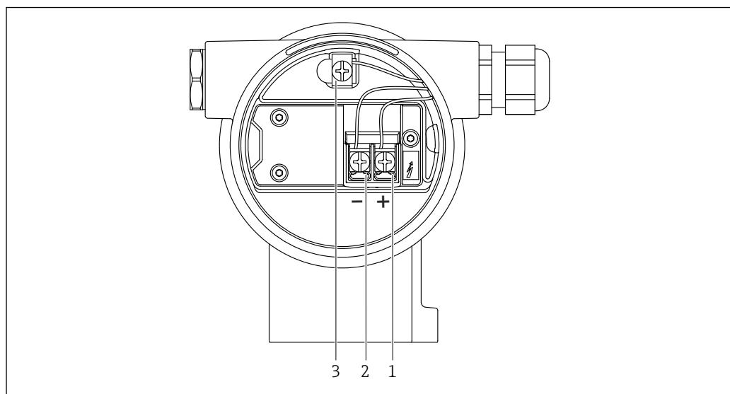
図 8 端子部の接続端子と接地端子
