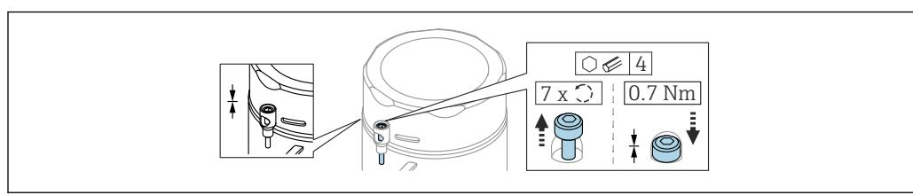
図6 固定ねじ付きカバー；サニタリハウジング（粉塵防爆用のみ）
