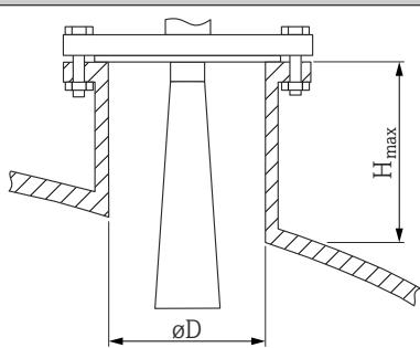
**i** これより長いノズルを使用した場合、測定性能が低下します
