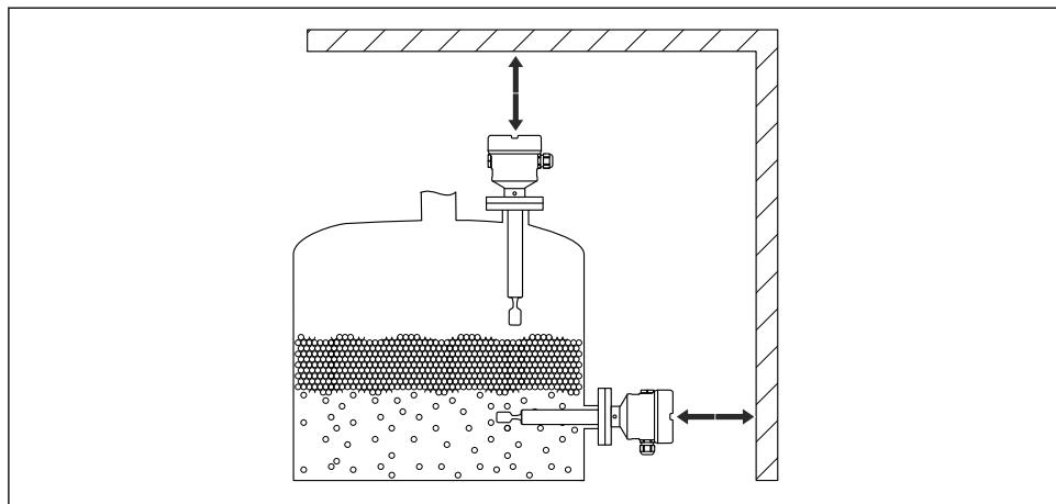
图 7 预留安装间隙
