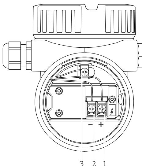
图 17 接线腔中的接线端子和接地端
