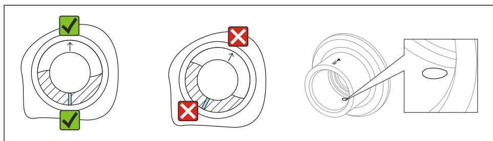
图 9 焊座，带泄漏检测孔
