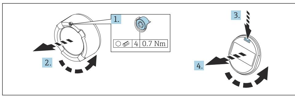
1. 如果已安装电子腔盖：使用内六角扳手松开电子腔盖锁扣螺丝。
