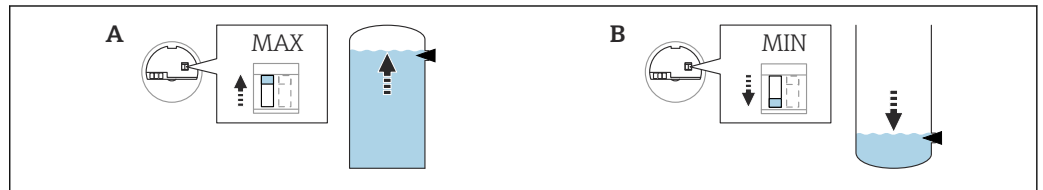
図 54 エレクトロニックインサートのフェールセーフモード MAX/MIN のスイッチ位置
