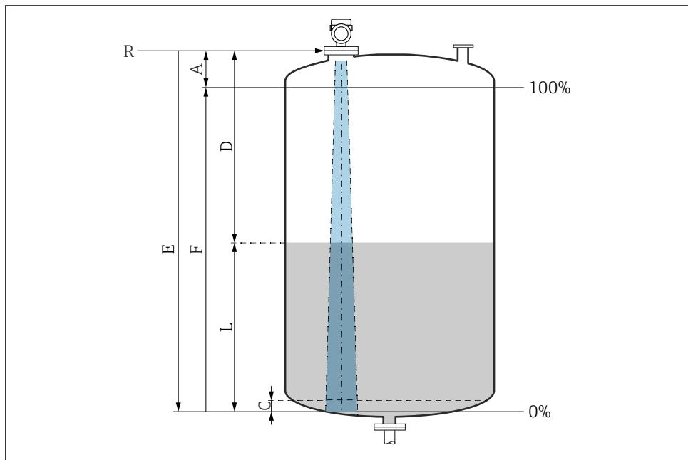
图 6 液位测量的设置参数
