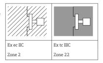
L'appareil est conçu pour le fonctionnement en atmosphère gazeuse ou poussiéreuse explosive comme indiqué dans le schéma ci-dessus. En cas d'apparition simultanée de mélanges gaz-air et poussière-air potentiellement explosifs : une évaluation plus poussée de la conformité est nécessaire.
