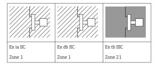
L'appareil est conçu pour le fonctionnement en atmosphère gazeuse ou poussiéreuse explosive comme indiqué dans le schéma ci-dessus. En cas d'apparition simultanée de mélanges gaz-air et poussière-air potentiellement explosifs : une évaluation plus poussée de la conformité est nécessaire
