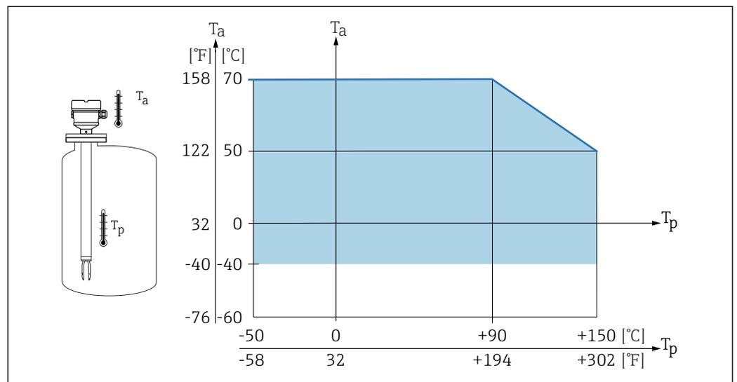
図 33 ハウジングの許容周囲温度  $T_a$  は、容器内のプロセス温度  $T_p$  に応じて異なります。
