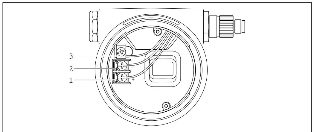
図 17 端子部の接続端子と接地端子
