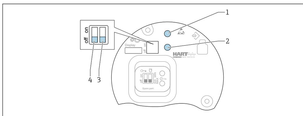
図 20 FEL60H エレクトロニックインサートの操作キーおよび DIP スイッチ
