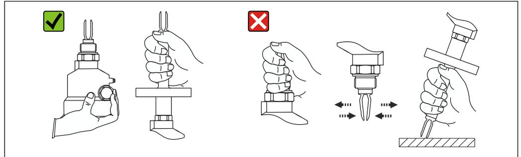
図 2 運搬中の機器の取扱い
