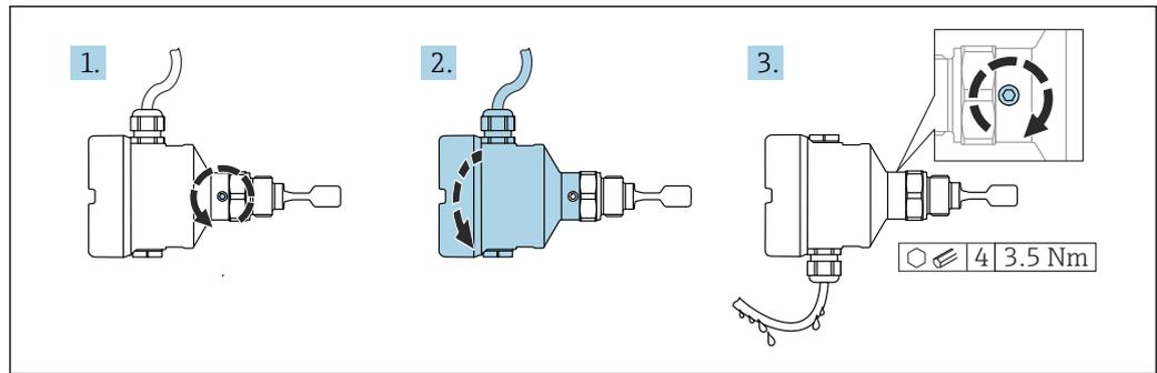
図 14 外部のロックネジおよびドリッブループ付きハウジング
