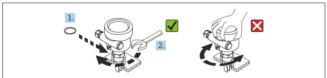
図 13 機器のネジ止め
