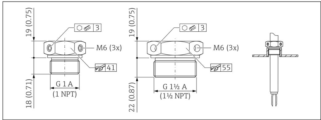
図 30 スライディングスリーブ (大気圧用 :  $p_e = 0 \text{ MPa}$  (0 psi))。測定単位 mm (in)
