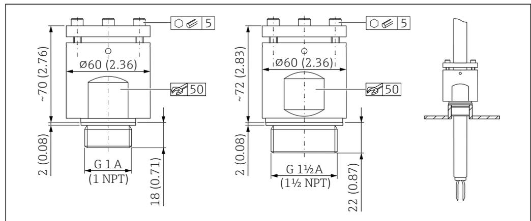
☑ 31 高压滑动套管。测量单位 mm (in)
