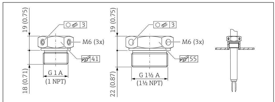
图 30 常压滑动套管  $p_e = 0$  bar (0 psi)。测量单位 mm (in)
