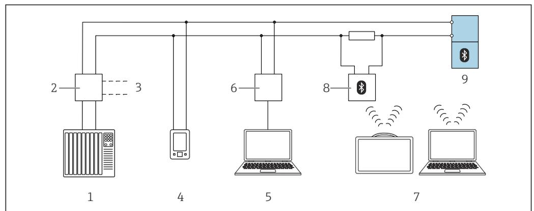
图 23 通过 HART 通信实现远程操作
