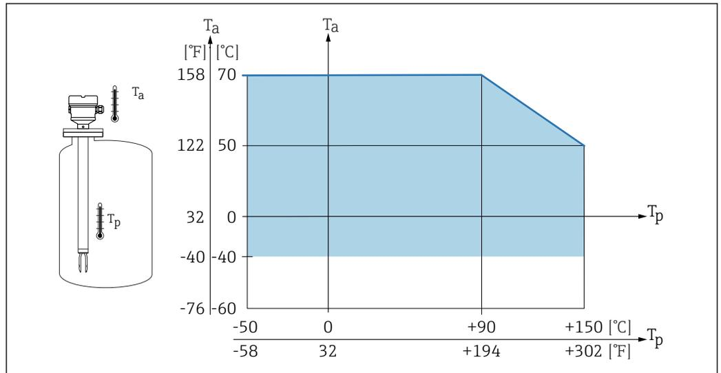
图 33 外壳允许环境温度  $T_a$  与罐体内部过程温度  $T_p$  的关系
