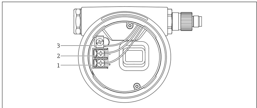
图 17 接线腔中的接线端子和接地端
