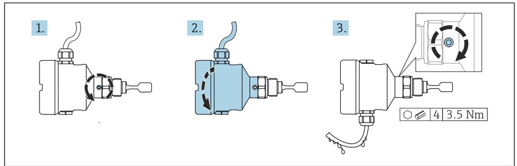
图 14 外壳带外部锁紧螺丝和排水回路
