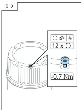
► Дополнительно: замок крышки
