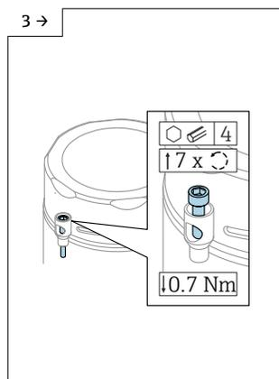
► Дополнительно: замок крышки на корпусе с одним отсеком в гигиеническом исполнении, 316L
